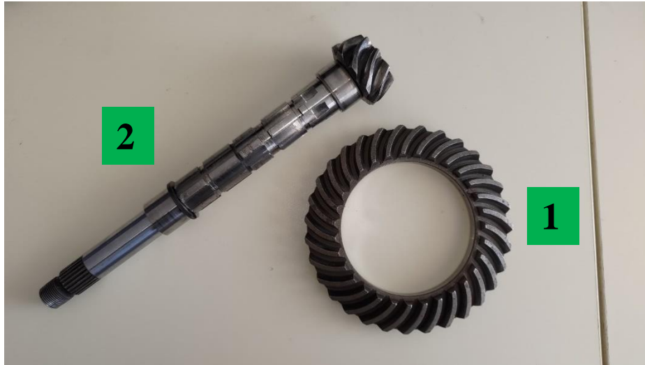
Obrázek č. 1 - Ozubené soukolí: 1) talířovité kolo; 2) ozubený pastorek.
