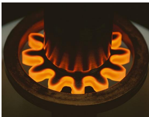
Obrázek č. 25 - Indukční kalení ozubeného kola [23].
