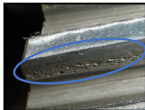
Obrázek č. 17- Progresivní pitting [15].
