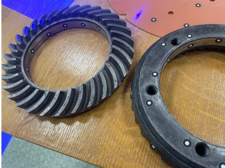
Obrázek č. 29 - Nalepené body na skenovaném ozubeném kole.
