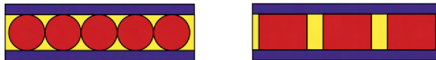
Obrázek 3.4: Průřez AFC (vlevo) a MFC (vpravo) kompozitem, Fialová - Elektroda, Žlutá - epoxid, Červená - PZT [20]
