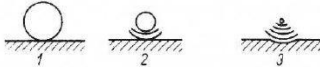
Obrázek 11 Průběh kavitačního opotřebení [21]
