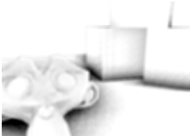
Obrázek 3.2: Výstup metody Screen space ambient occlusion .
