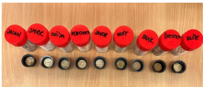
Obrázek 16: Slisované vzorky – tablety jednotlivých druhů dřevní biomasy (foto autorka)
