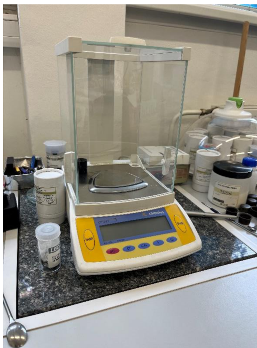
Obrázek 11: Laboratorní váhy Sartorius SP124 S (foto autorka)
