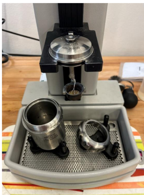
Obrázek 17: Sestavení spalovací bomby s připraveným vzorkem (foto autorka)
