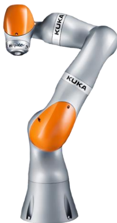
Obr. 12) Kolaborativní robot KUKA LBR iiwa 14 R820 [42]
