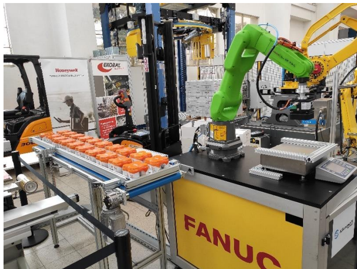
Obr. 22) Kolaborativní robot Fanuc CR-7iA/L manipulující s balením plechovek
