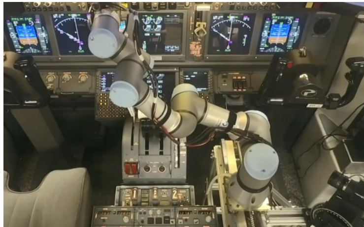
Obr. 17) Kolaborativní robot Universal Robot UR3 zastávající funkci kopilota [20]
