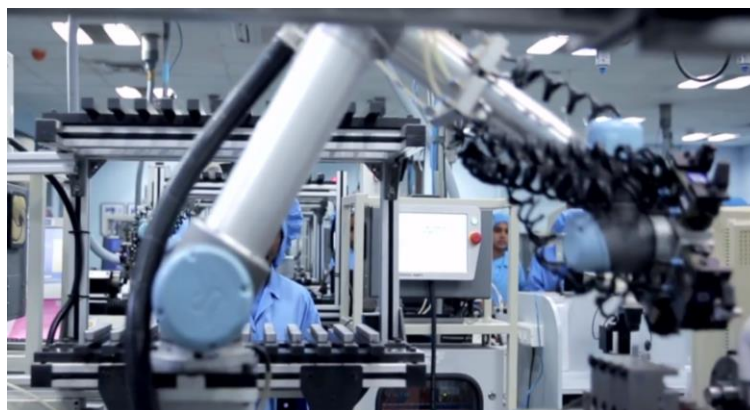
Obr. 21) Kolaborativní robot Universal Robots UR5 zakládající přípravky do regálu [22]
