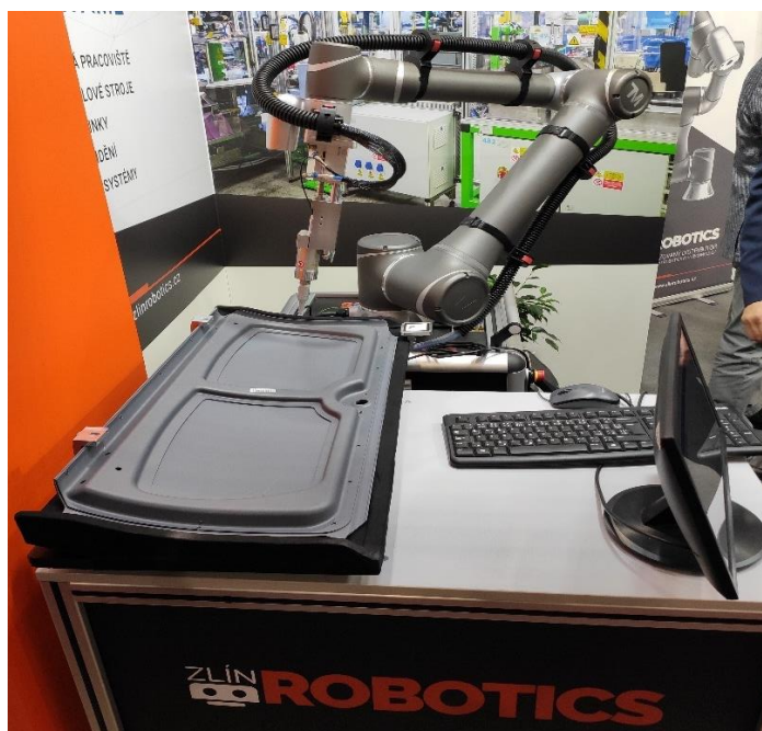
Obr. 23) Kolaborativní robot Techman TM 5-900 dotahující šrouby panelu sedadla automobilu
