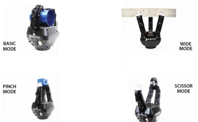
Obr. 35) Režimy uchopení předmětů koncového efektoru 3-FINGER ADAPTIVE ROBOT GRIPPER [30]
