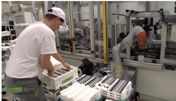
Obr. 18) Kolaborativní robot Kuka ve výrobním závodě Škoda Vrchlabí podílející se na výrobě přímo řazených převodovek DQ 200 [46]
