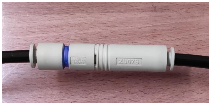
Obr. 80) Použitý inline podtlakový ejektor na provedení zkoušek
