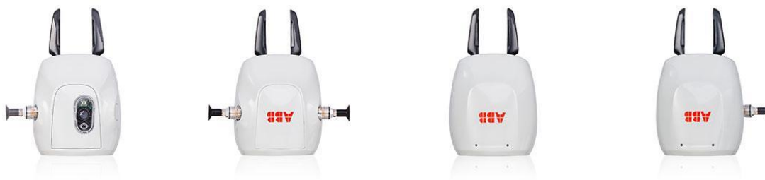
Obr. 14) Možná provedení koncového efektoru pro kolaborativní robot ABB YuMi [44]
