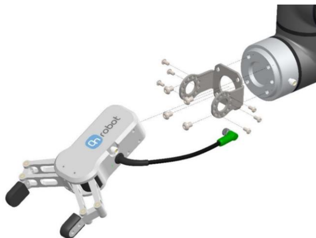
Obr. 27) Znáznornění montáže koncového efektoru RG2 GRIPPER [23]
