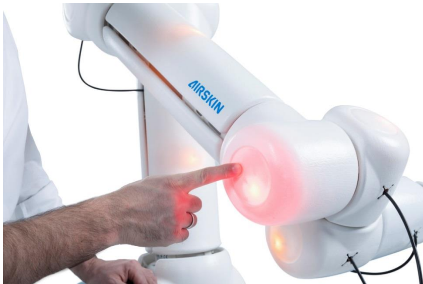
Obr. 8) Rozšíření AIRSKIN® na kolaborativním robotu UR 10 plní funkci „sensitive skin“ [38]
