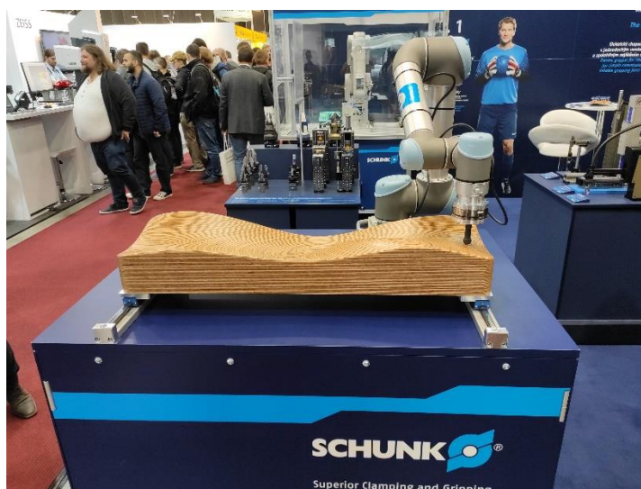
Obr. 25) Kolaborativní robot Universal Robots UR5 obrábějící dřevo
