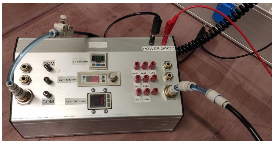
Obr. 73) Zkušební box měřící objemový průtok na vstupu podtlakového ejektoru
