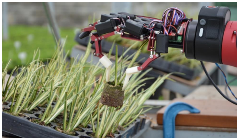
Obr. 16) Kolaborativní robot Sawyer manipulující s rostlinami [20]
