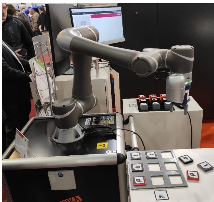
Obr. 24) Kolaborativní robot Techman TM 5-900 umísťující kostičky do příslušných polí
