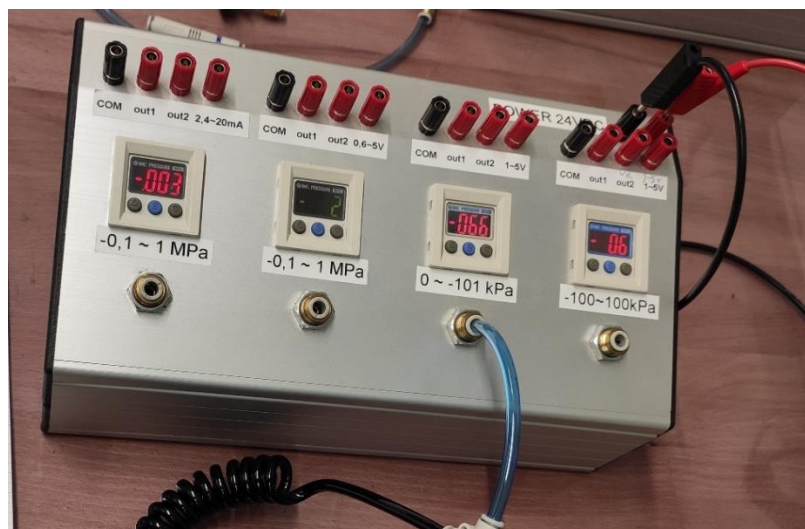
Obr. 81) Skutečná hodnota vytvořeného vakua v okamžiku uchopení nejmenšího uvažovaného štítku
