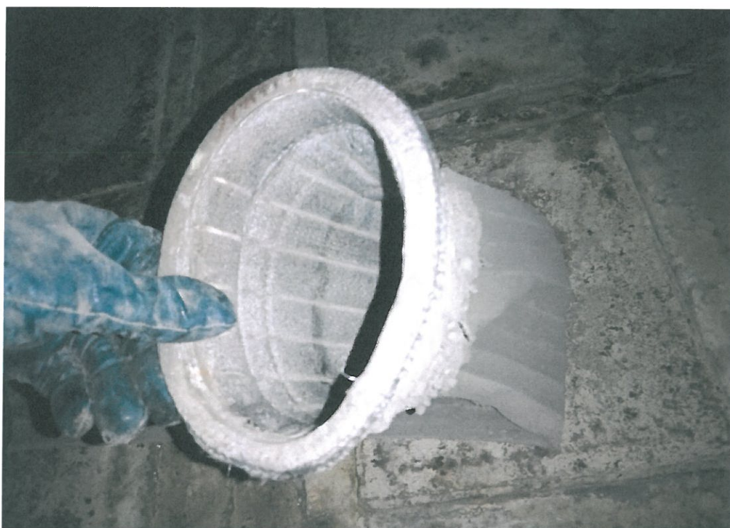
Obr.6. Tkaninové filtry (9m délka, vyztužená zevnitř klecí)
