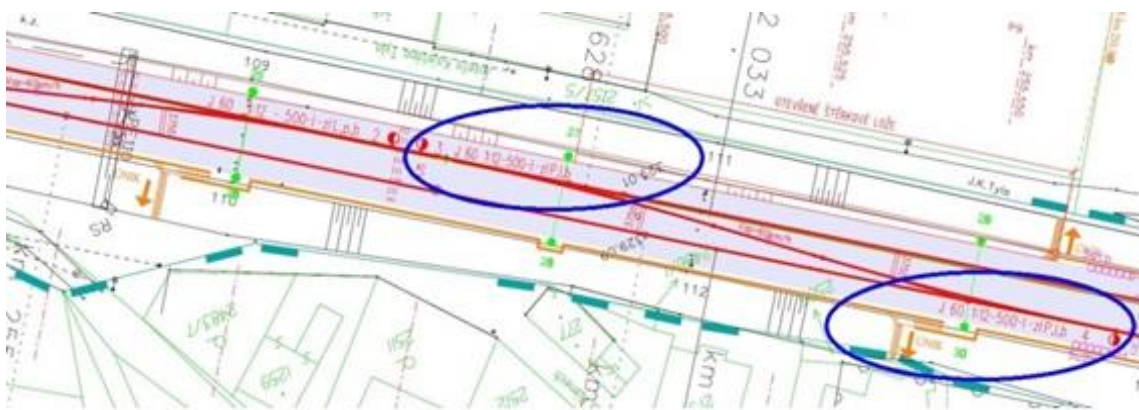
Obrázek 9 Schéma jednoduché kolejové spojky ve zkušebním úseku
