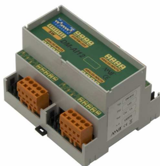
Obr. 6.2: Modul analogových vstupů DM-AI12
