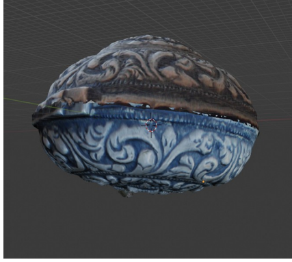
Obr. 63 Barokní anglické kapesní vřetenovky, kolem r. 1730, Anglie, spodní díl z 32 snímků (program 3DF Zephyr Free).
