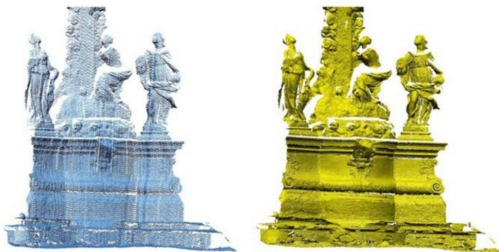
Obr. 12 Na obrázku je vlevo znázorněné mračno bodů a vpravo model, který je už definovaný tzv. polygonovou sítí (zdroj: Brejcha a kol, 2015).
