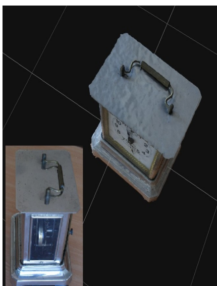
Obr. 33 Ukázka nedokonalostí na povrchu 3D modelu z důvodu lesklého povrchu objektu, budík skříňkový Junghans, 1890 – 1920, Německo.
