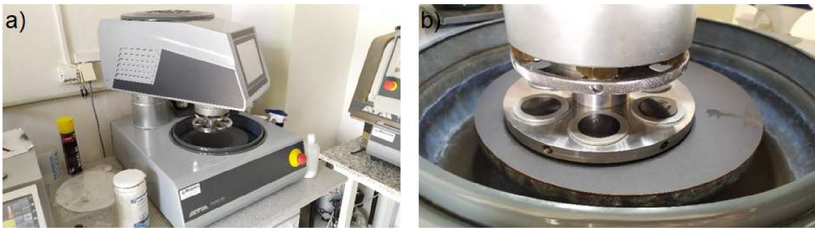
Obr. 19 a) Metalografická bruska SAPHIR 550, b) vzorky v revolverovém držáku brusné hlavy
