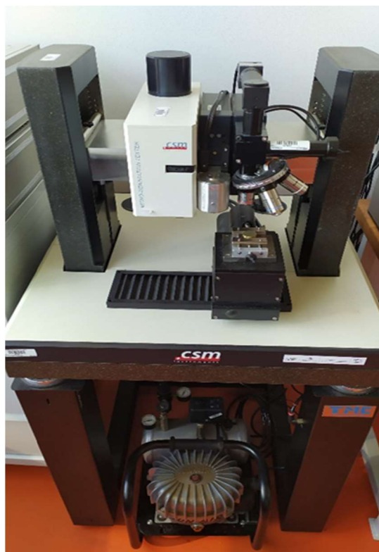
Obr. 31 Mikro a nanotvrdoměr firmy CSM Instruments
