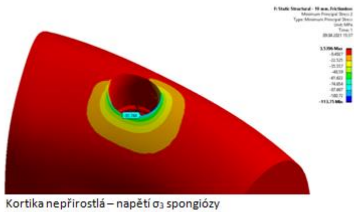
Obrázek 33 - Výsledky hlavního napětí - nepřirostlá kortika pro implantát A10
