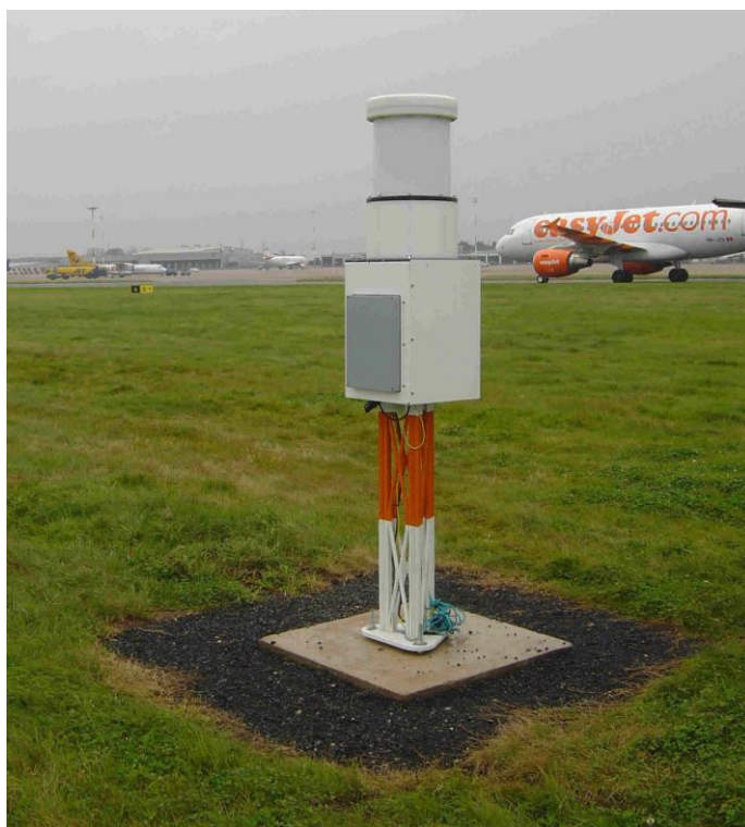
Obr. 8 Hlava přijímače/vysílače milimetrového radaru [10]
