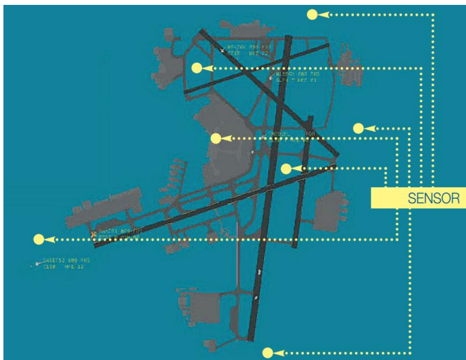
Obr. 11 Příklad rozmístění přijímacích stanic [13]
