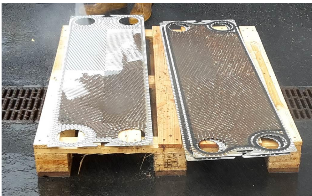
Obr. č. 16 – Desky výměníku Tranter zanesené kalem [zdroj: vlastní].
