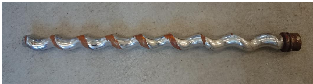
Obr. č. 12 - Opatřebovaný rotor podávacího čerpadla Seepex [zdroj: vlastní].
