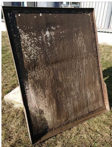
Obr.č. 15 – Zanesené síto (1 mm) z jímky na provozní/chladicí vodu [zdroj: vlastní].
