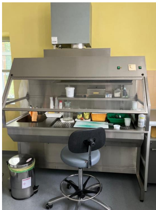
Obr. 8: Odvětrávaný box na přikrajovacím pracovišti (zdroj: vlastní)
