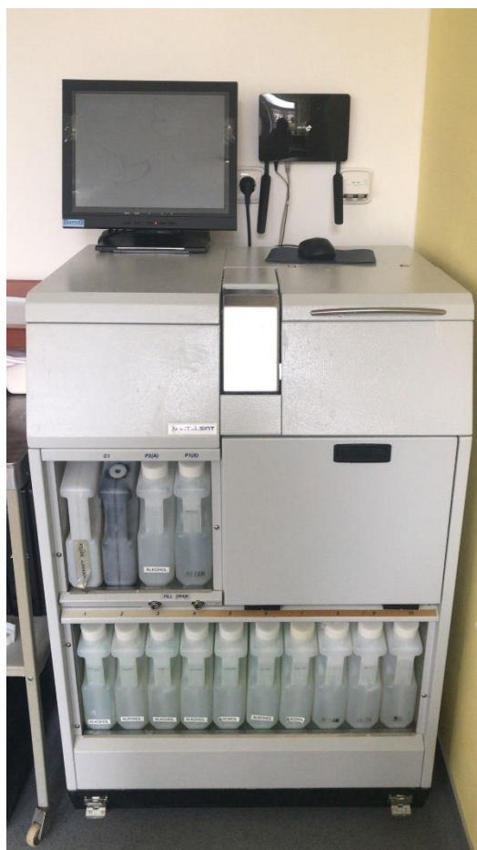
Obr. 9: Standardní vakuový tkáňový procesor (autotechnikon) (zdroj: vlastní)
