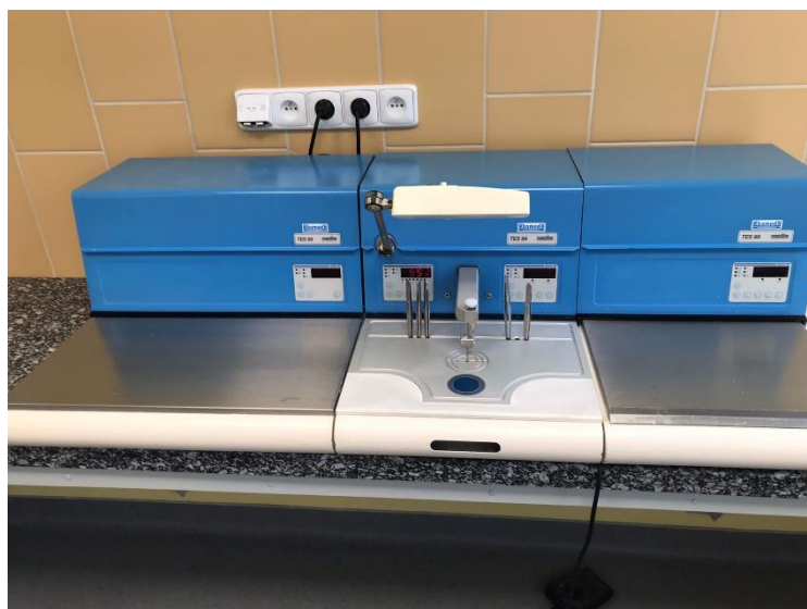
Obr. 10: Parafinová zalévací linka – součástí je i přehřívací parafinová lázeň (zdroj: vlastní)
