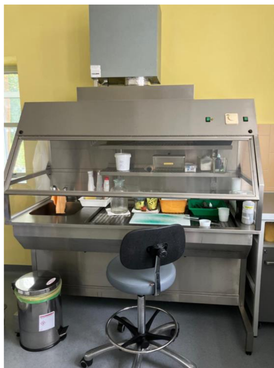
Obr. 8: Odvětrávaný box na přikrajovacím pracovišti (zdroj: vlastní)
