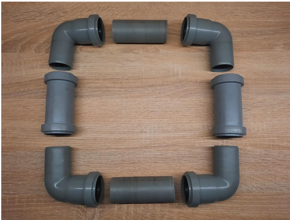
Obr. 2. Části plováku v rozloženém stavu
