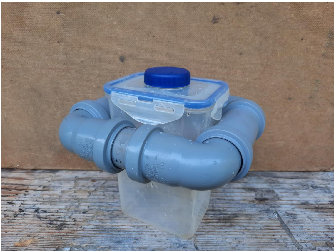
Obr. 5. Celkový pohled na kompletně sestavenou past bez závaží, původně umístěných ve víku.
