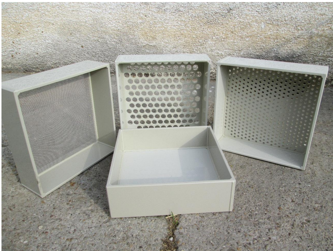
Příloha 1 Penn State separátor částic – jednotlivá síta a dno.
