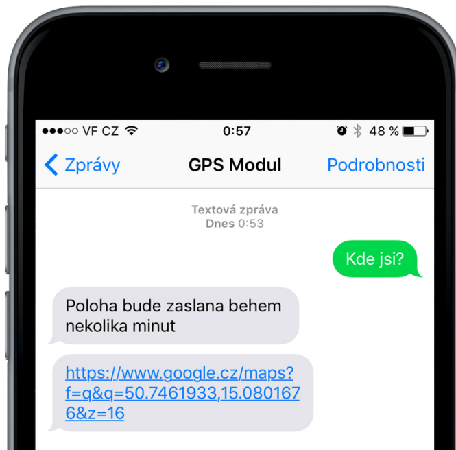
Obrázek 6.2: Příklad komunikace se sledovacím zařízením
