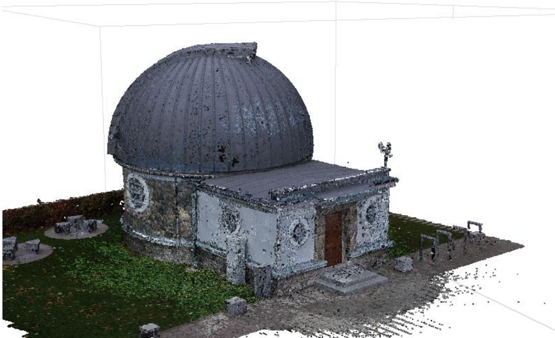
Obrázok 34: Husté mračno z mobilného telefónu po úprave
