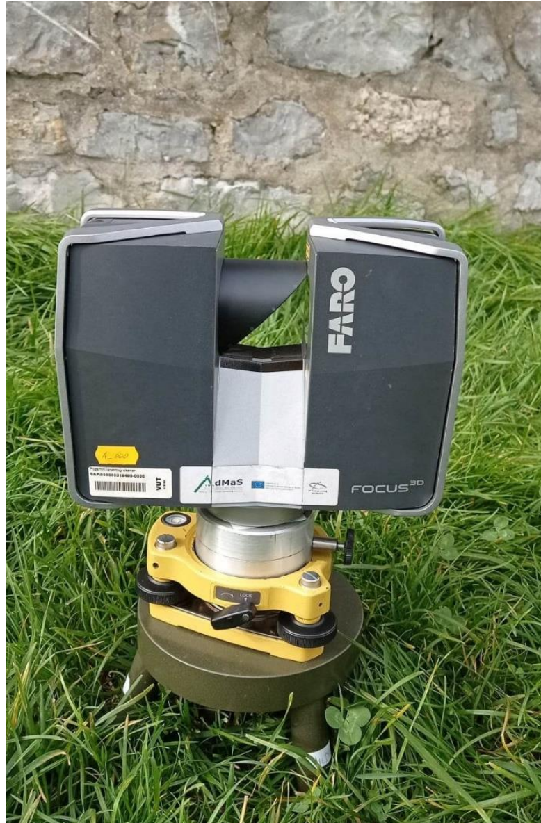
Obrázok 2: Skener Faro Focus 3D X130 na ministatíve
