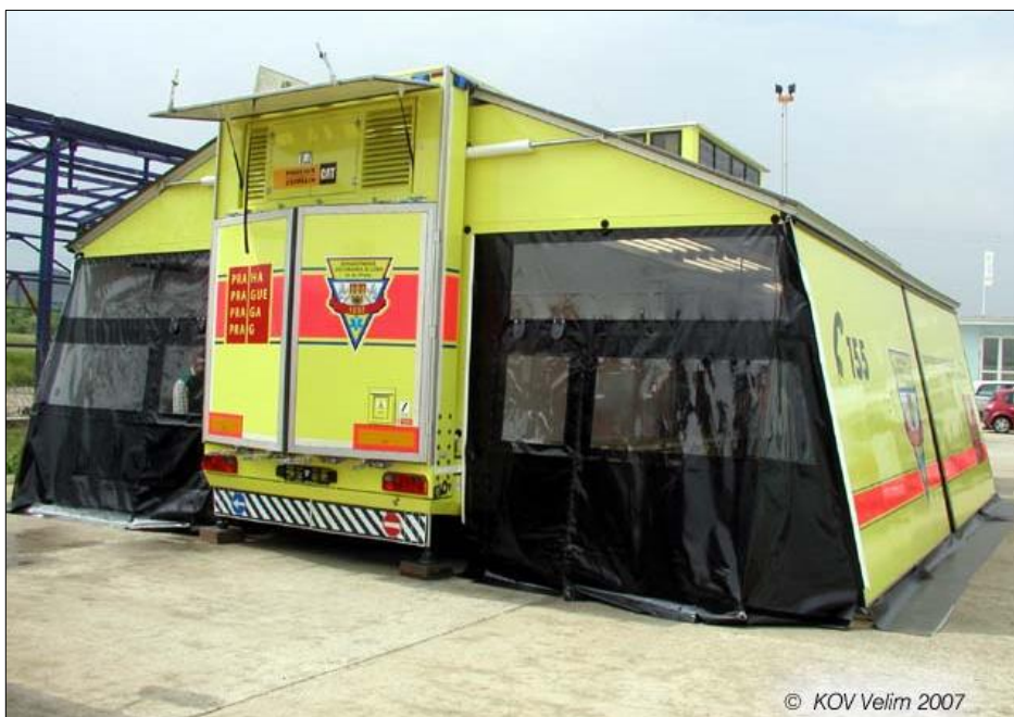
Obrázek 23 - Modulární systém GOLEM pro HN - ZZS HMP - zadní pohled na rozložený modul ( http://www.kov.cz/ )
