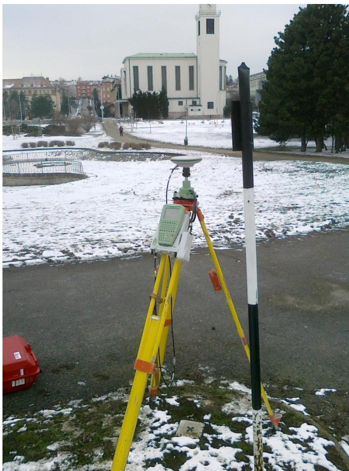
Obr. 13- Měření metodou RTK na bodě 4301-216.1
