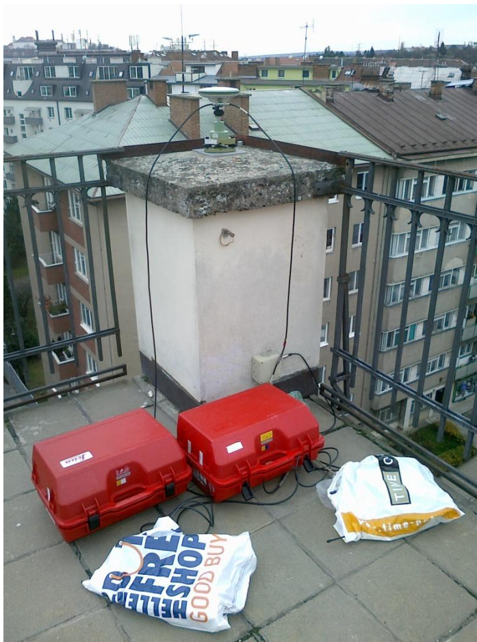
Obr. 12- Měření statickou metodou na pilíři
