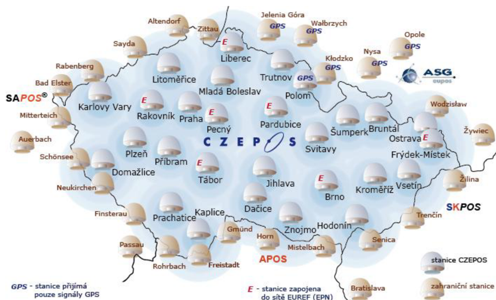
Obr. 3- Rozmístění referenčních stanic CZEPOS [18]
