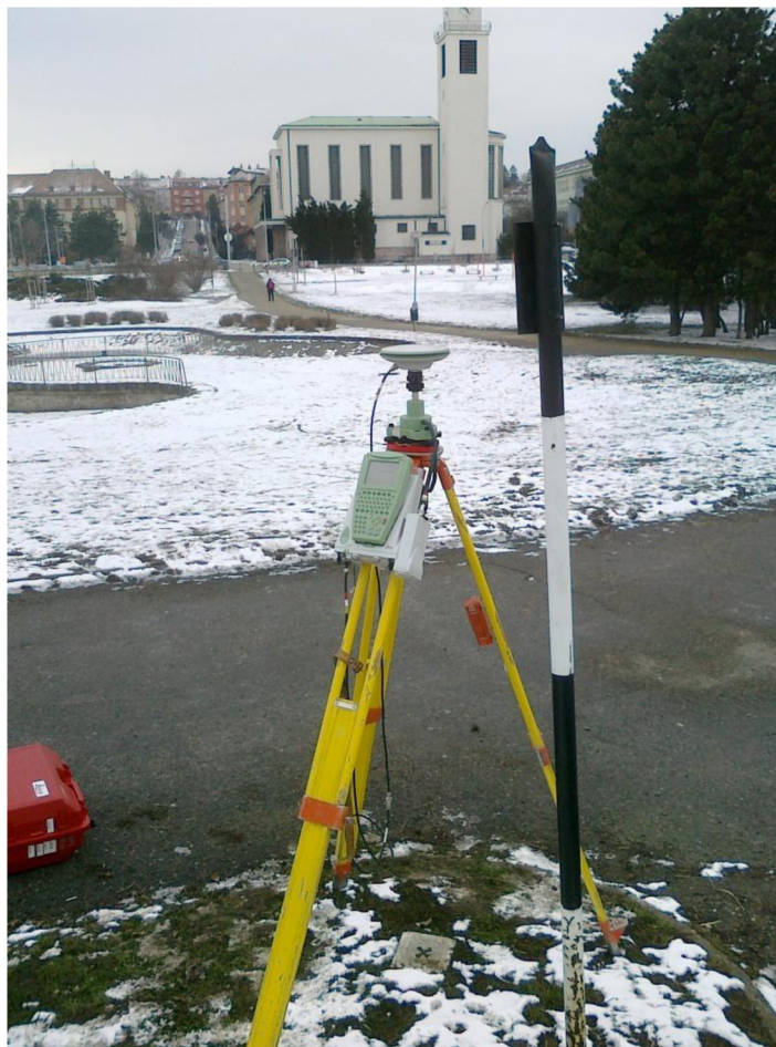
Obr. 13- Měření metodou RTK na bodě 4301-216.1
