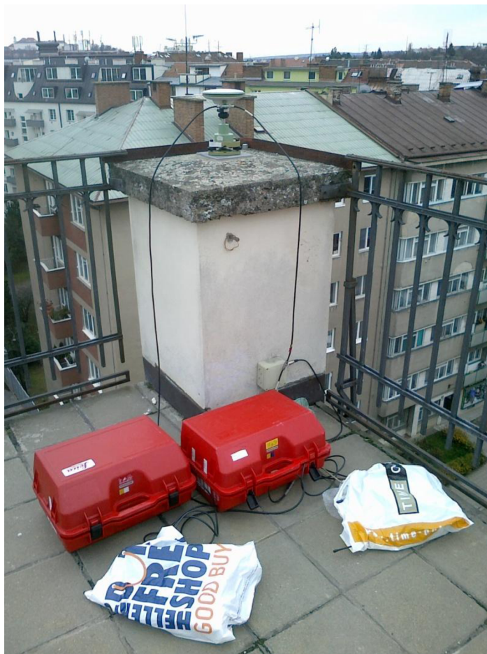
Obr. 12- Měření statickou metodou na pilíři
