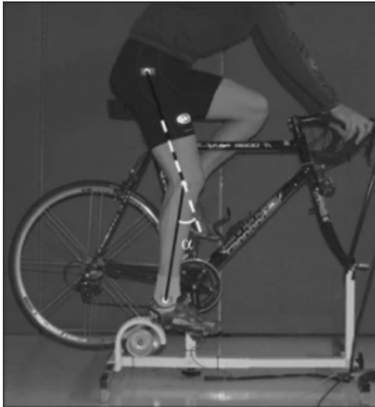
Obr. 1.4: Príklad nastavenia výšky sedla na základe Holmesovej metódy (prevzaté z [39])
