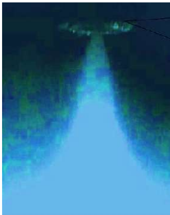
Obrázek 5.4: Formování hydrátu pomocí dvojité trysky
