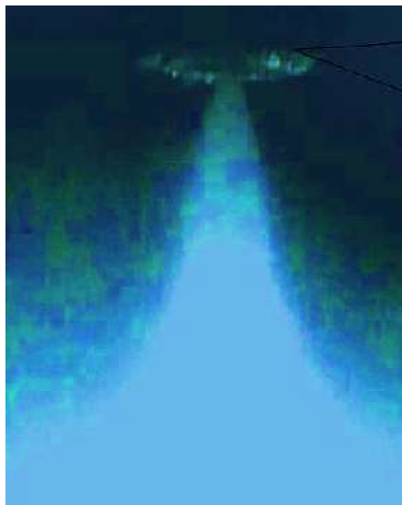
Obrázek 5.4: Formování hydrátu pomocí dvojité trysky
