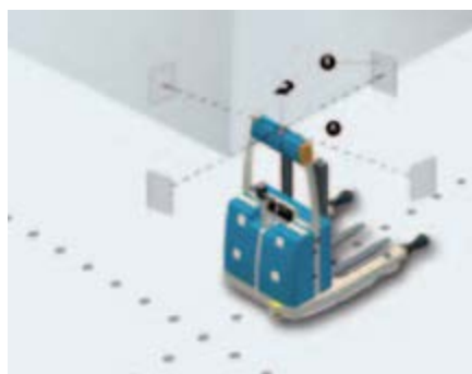
Obr. 23 Magnetická navigace, zleva: standardní, kombinovaná s laserovou [4], [28]
