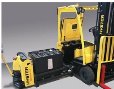
Obr. 5 Vyjmutí baterie z vozíku [9]
