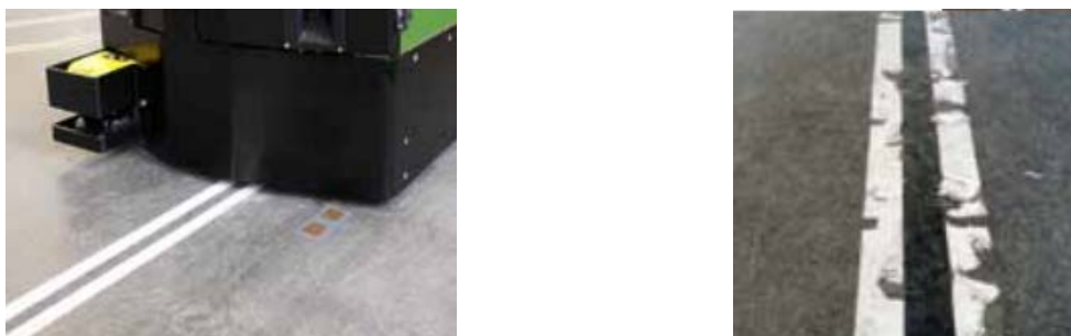
Obr. 20 Optická navigace, zleva: vyznačená jízdní trasa, opotřebování pruhu [3]
