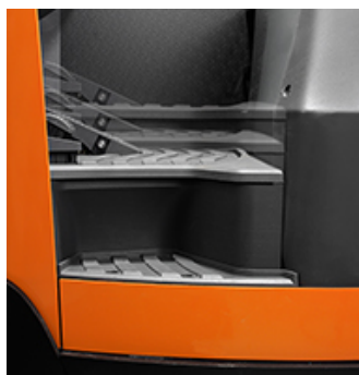
Obr. 31 Polohovatelná výška podlahy [7]
