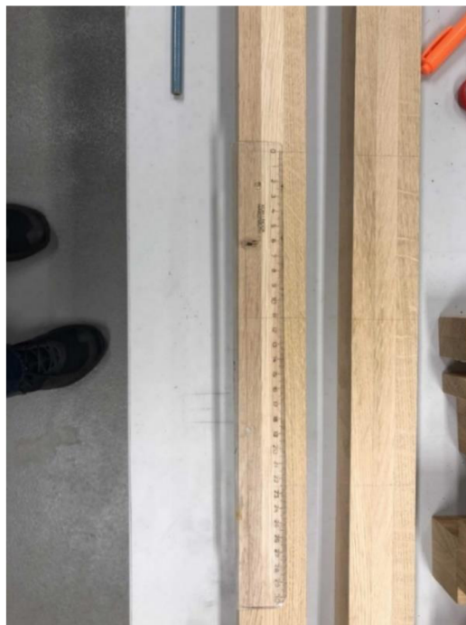
Obrázek 19 Příprava zkušebních referenčních nosníků pro realizaci zkoušky ohybem Zdroj: Autor práce
