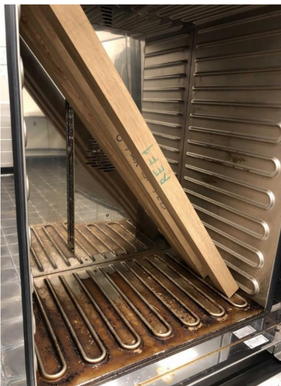
Obrázek 17 Uložené nosníky v sušárně Zdroj: Autor práce
