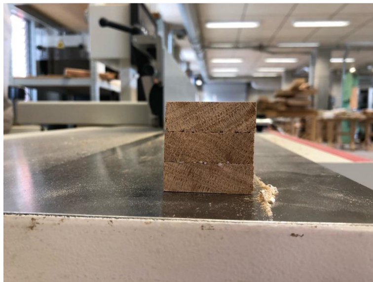
Obrázek 13 Nosník po opracování na přesný rozměr Zdroj: Autor práce
