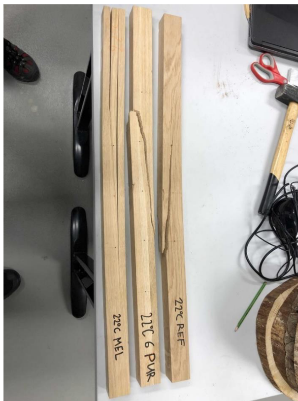
Obrázek 15 Referenční nosníky po klimatizování při 22 \pm 2 \text{ }^\circ\text{C} a 65 \pm 5 \% po realizaci zkoušek zatížení
