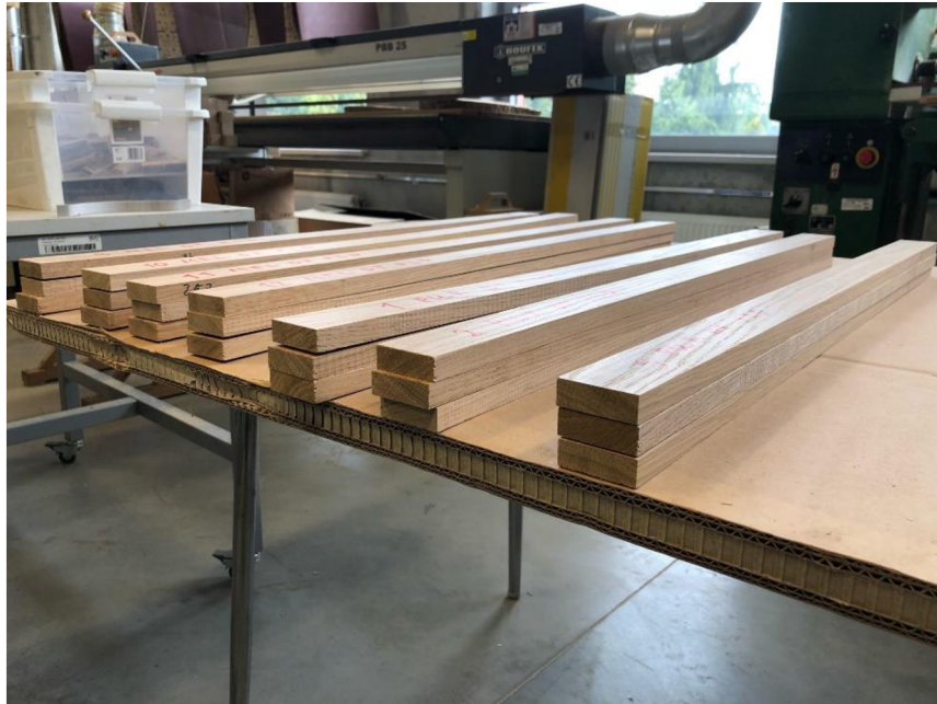
Obrázek 10 Lamely po opracování na srovnávací a tloušťkovací frézce Zdroj: Autor práce
