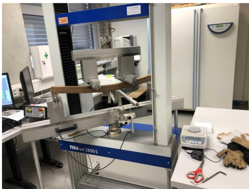
Obrázek 20 Trhací stroj TIRATEST 2850 S (Tira, Schalkau, Německo) Zdroj: Autor práce
