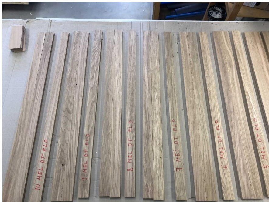
Obrázek 11 Příprava lamel pro nános adhesiva Zdroj: Autor práce
