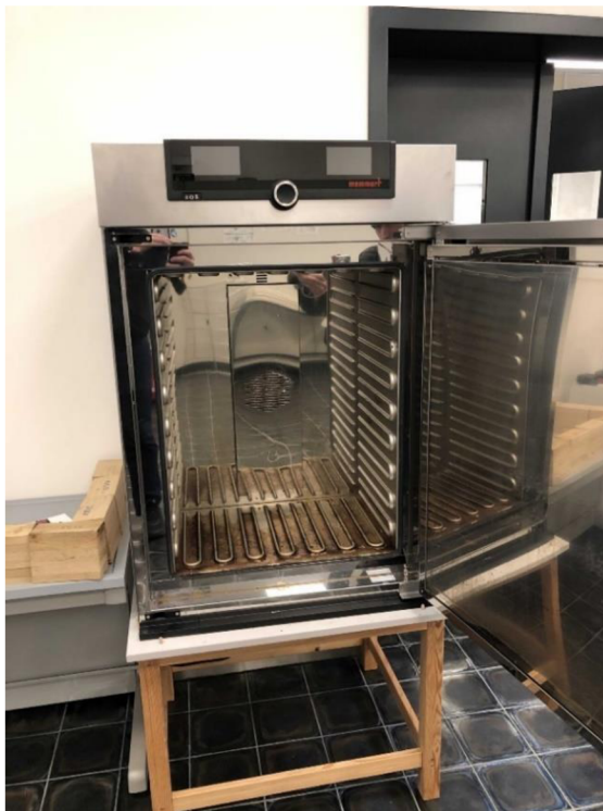
Obrázek 16 Termokomora typu Memmert UF55 (Memmert GmbH, SRN) Zdroj: Autor práce
