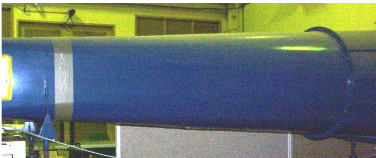
Obr.13 Typický difúzor s expanzívny charakterom[22]
