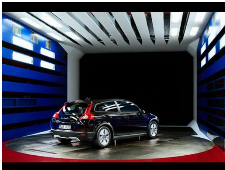
Obr. 24 Natočenie vozidla v aerodynamickom tunely o plus 30 stupňov voči prúdeniu vzduchu[14]
