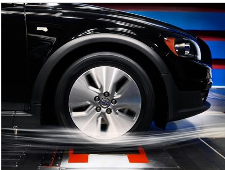
Obr.23 Testovanie prúdenia vzduchu v oblasti podvozku a kolies pri simulovaní jazdy[13]
