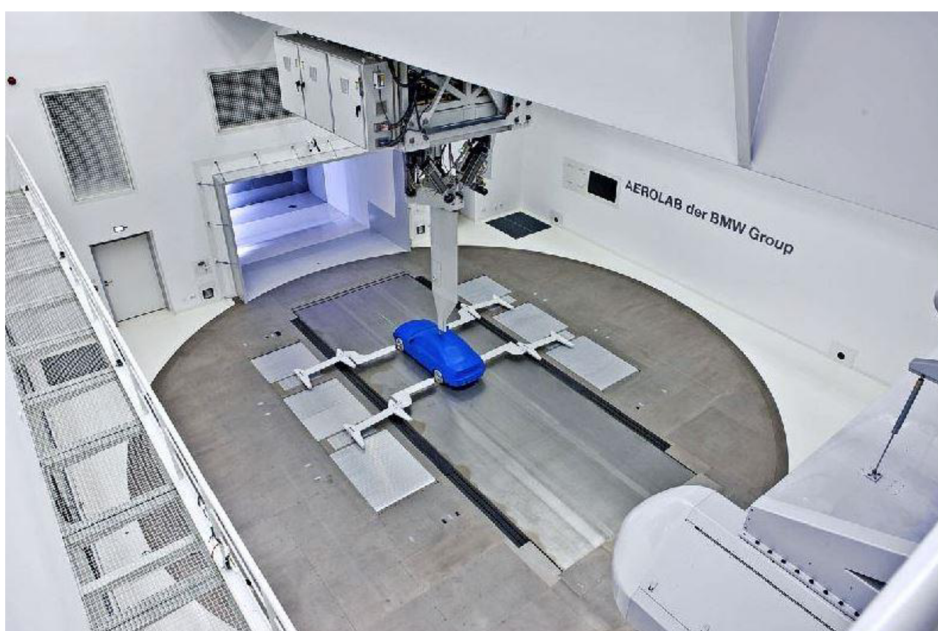
Obr. 17 Testovacia oblasť v BMW Aerolab[16]
