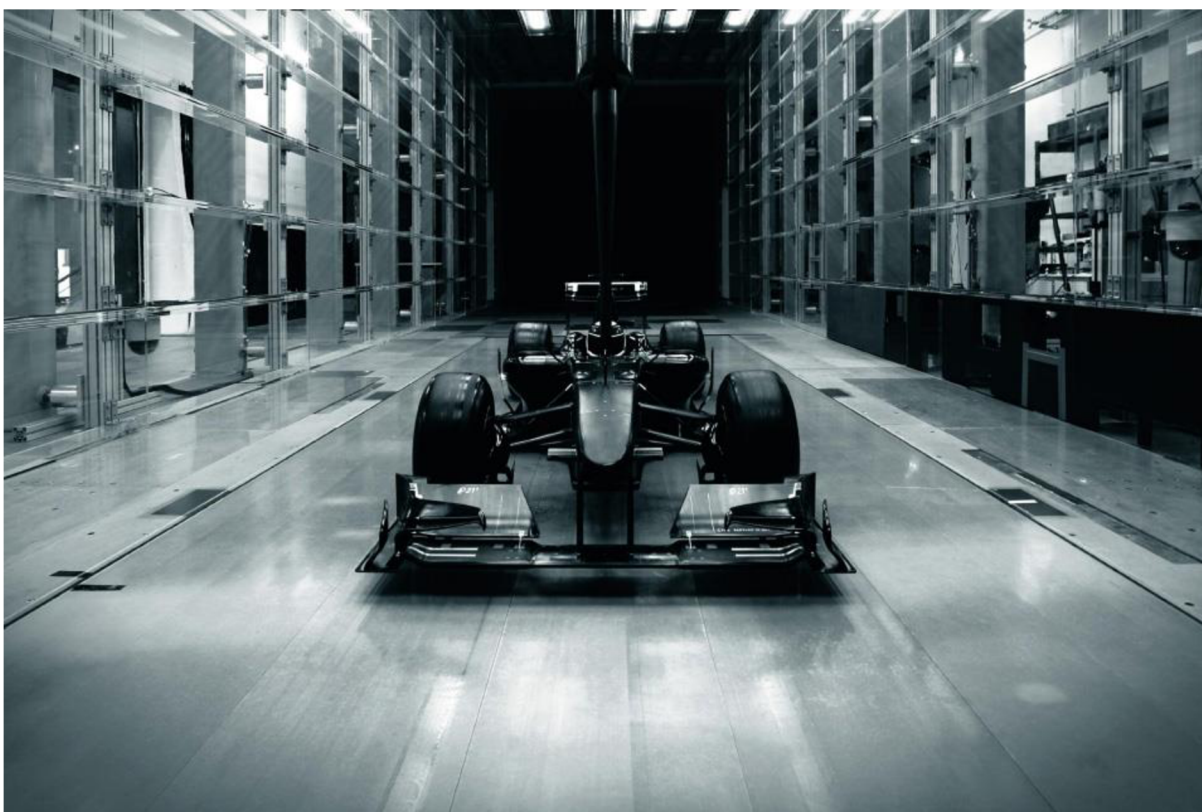
Obr.27 Testovanie v aerodynamickom tunely na pohyblivom páse Toyoty s konštrukciou pre laserovú anemometriu PIV [24]
