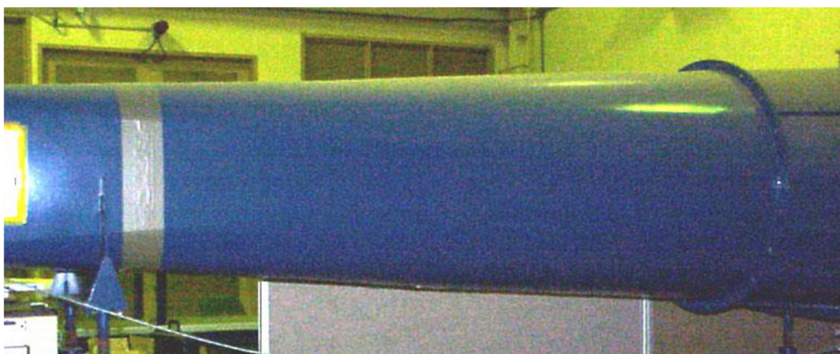
Obr.13 Typický difúzor s expanzívnym charakterom[22]
