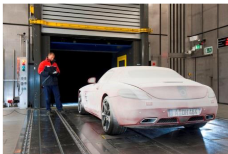
Obr. 22 Testovanie v chladnovzdušnom tunely[8]
