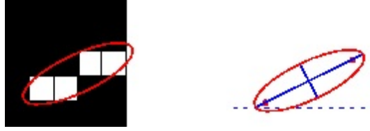
Obrázek 6: Princip funkce regionprops('Orientation') [10]
