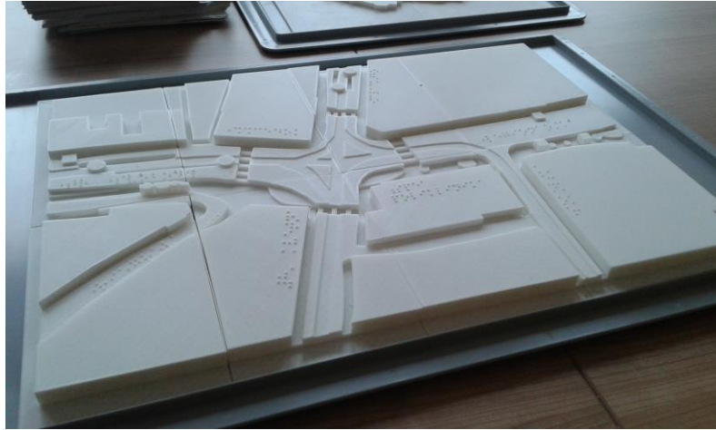
Obr. 6.2 Tyflomapa vytisknutá nízkonákladovou 3D tiskárnou
