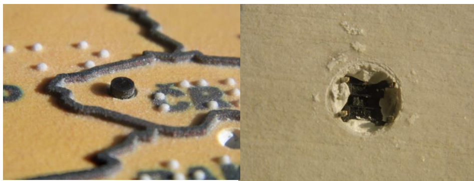
Obr 4.2 Nainstalované tlačítko v tyflomapě – horní a spodní strana tlačítka
