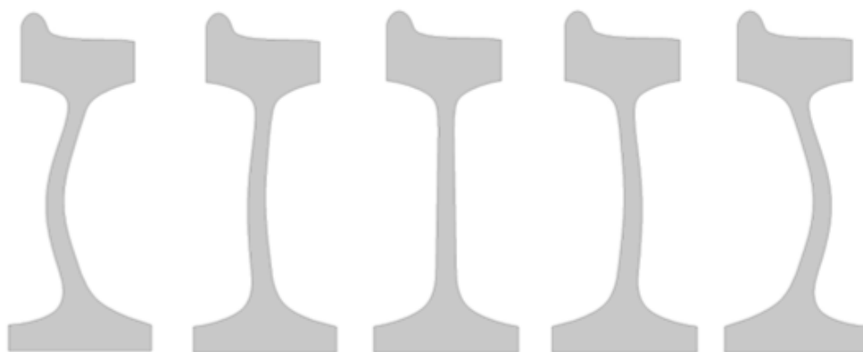
Obr. 53 - Ukázka tvarů profilu kola s parametrem A=(-30,-10,0,10,30) mm
