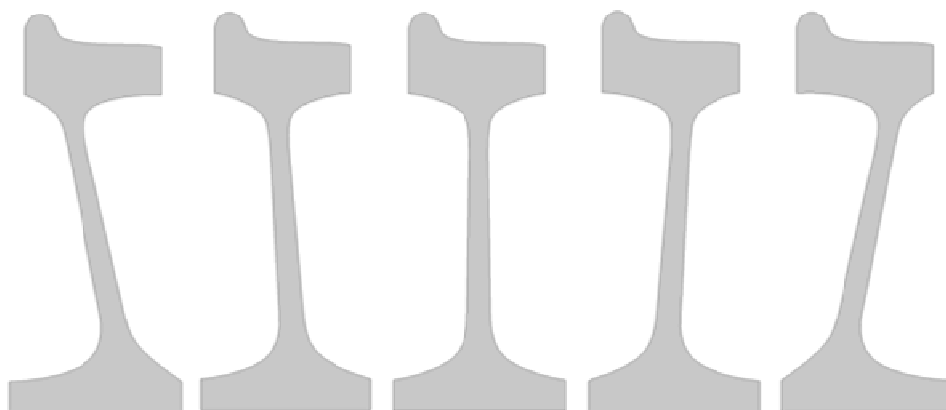
Obr. 60 - Ukázka tvarů profilu kola s parametrem V_1=(-30,-10,0,10,30) mm, V_2=-V_1
