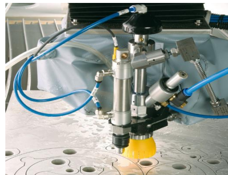
Obr. 6 Řezání vodním paprskem [23]
