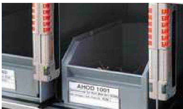
Obrázek 2 - Výběrová čidla pro zobrazení správné pozice odebrání součásti
