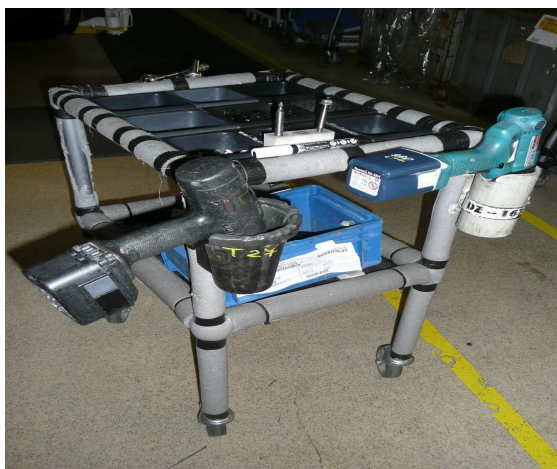
Obrázek 13 - Pojízdný vozík na materiál a utahovací nářadí systém TRILOGIQ
