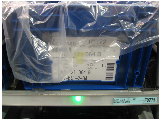
Obrázek 8 - Signalizace materiálu k odběru
