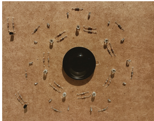
Obr. 4.2: Doska s ledkami a objektívom. Ide o vrchnú časť modulu, ktorý sa zasúva do kartónovej krabice.
