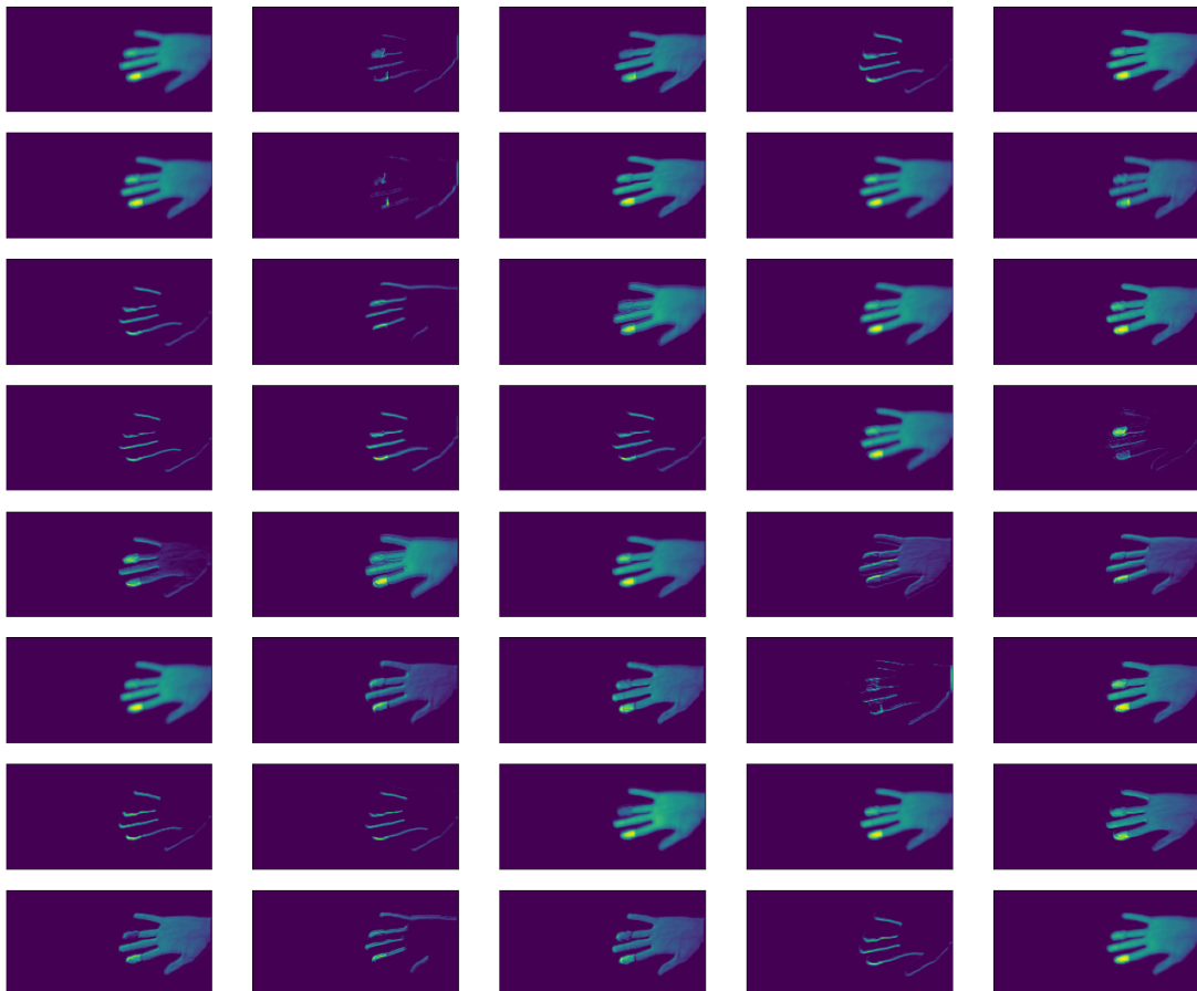
Obr. 4.8: Mapa vlastností ( feature map ) z prvej konvolučnej vrstvy v poradí. Použitý bol snímoklivej ruky s 2 odtlačkami vyrobenými z 2 tvarovacích hmôt s odlišnou mierou odrazivosti v infra svetle. Zobrazených je 40 z celkových 64 snímokov, ktoré tvoria mapu.
