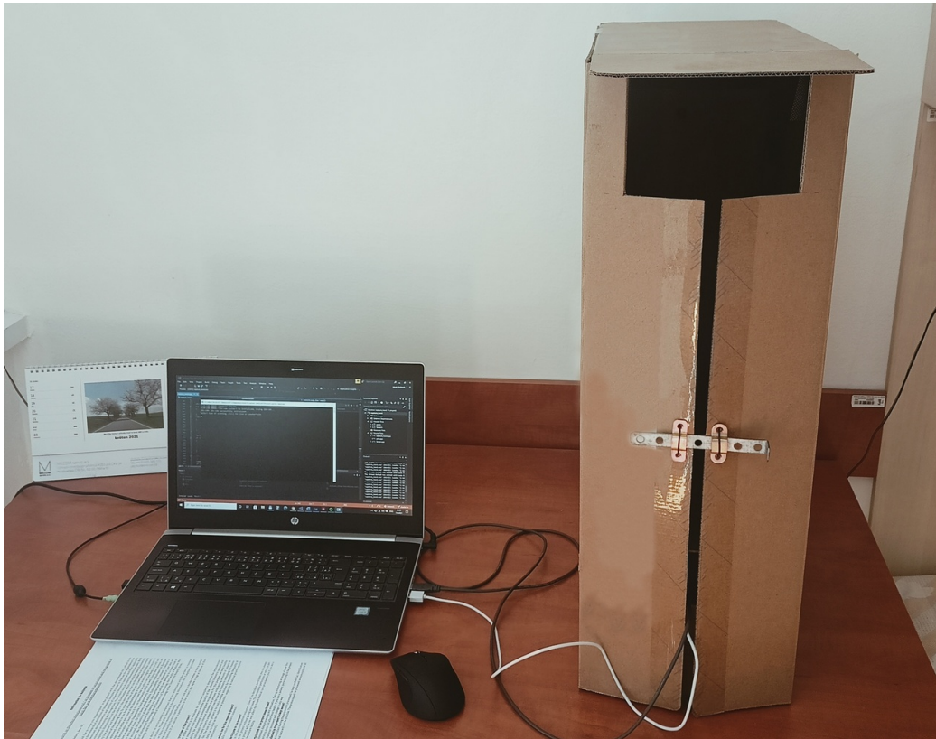
Obr. B.1: Výsledné zariadenie - kartónová krabica, obsahujúca zásuvný modul s kamerou a arduinom, pripojenými k PC. Štrbina v uzávere krabice nijako neovplyvňovala snímanie, keďže senzor kamery nebol na tolko citlivý.
