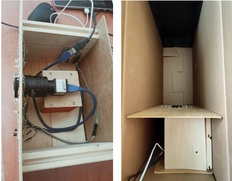
Obr. B.2: Naľavo pohľad do vnútra zásuvného modulu, kde arduino sprostredkuje uzemnenie a zdroj pre napájanie LED. 2 digitálne piny slúžia na spínanie MOSFET tranzistorov, riadiacich rozsvietenie jednotlivých druhov LED. Kamera je skrutkou upevnená k podstavci. Na obrázku vpravo je už podstavec umiestnený v krabici na výšku, tak aby kamera spolu s LED diódami smerovali nahor. Horná vnútorná stena krabice je vystlaná netkanou textíliou, tvoriacou pozadie na snímkach ruky.
