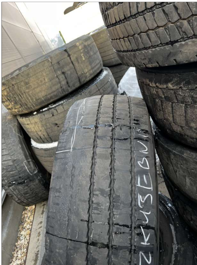
Obrázek 4.8: Opotřebení pravé přední pneumatiky po 66 139 km. Je viditelné silně asymetrické opotřebení v oblasti vnějšího ramene. [vlastní]
