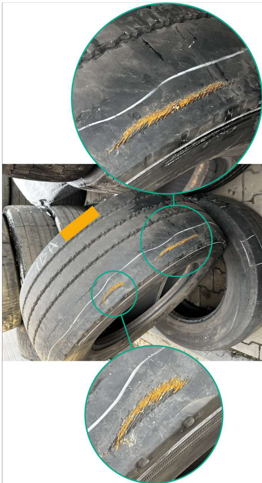
Obrázek 4.7: Opatřebení pravé přední pneumatiky po 66 139 km. Je viditelný odhalený první nárazník. [vlastní]
