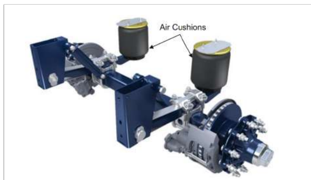
Obrázek 2.40: Náprava těžkého nákladního vozidla se dvěma vzduchovými měchy. [2]
