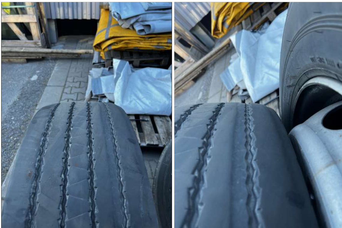
Obrázek 4.10: Opotřebení předních pneumatik po sundání po 143 367 km provozu s mírně zvýšenou sbíhavostí. [vlastní]
