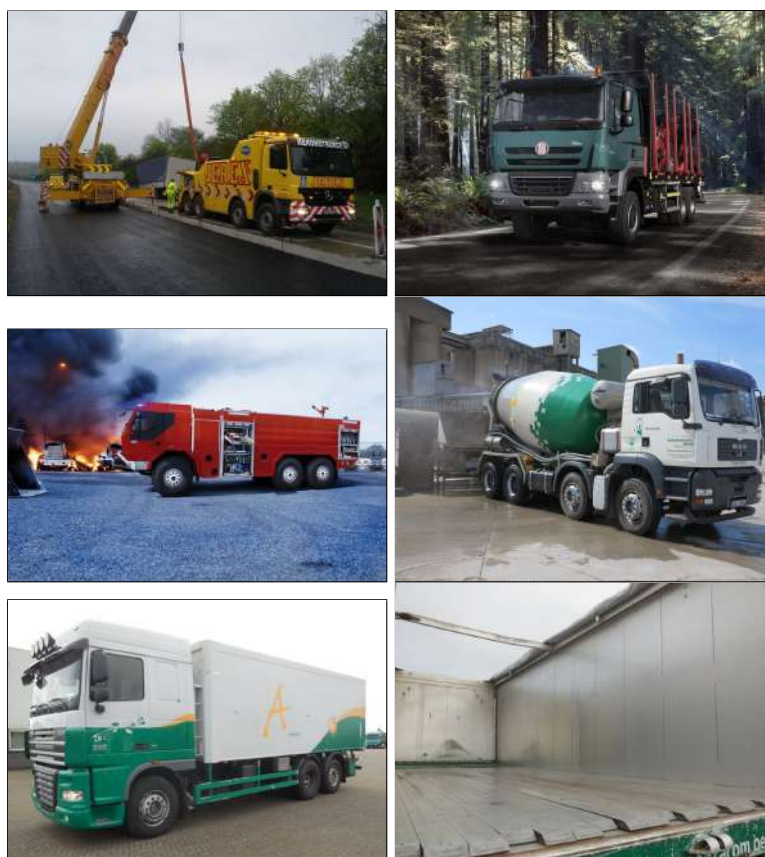
Obrázek 2.8: Výběr speciálních nákladních vozidel. Shora zleva: odtahovkový vyprošťovací speciál, přepravník dřeva Tatra, hasičský vůz Tatra, domíchávač MAN, posuvná podlaha zvenčí a zevnitř nákladového prostoru. [1] [10] [17] [18] [21]
