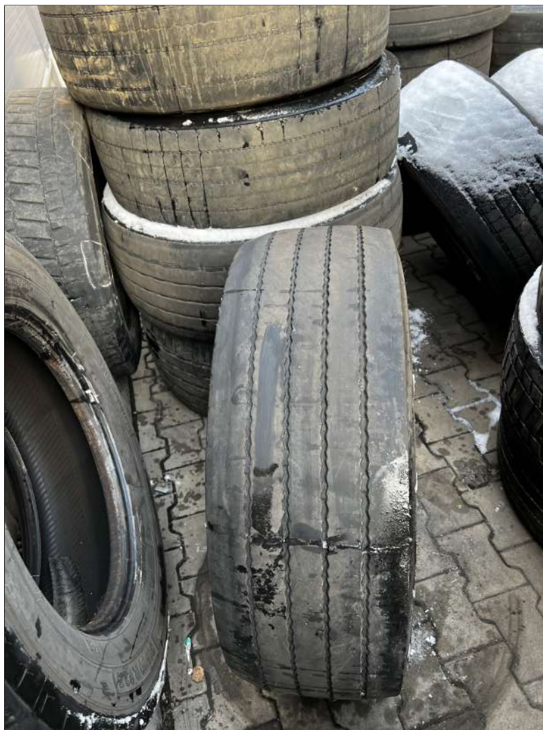
Obrázek 4.9: Opotřebení levé přední pneumatiky po 66 139 km. Rovněž je viditelná značná asymetrie opotřebení, avšak celkově byla tato pneumatika poškozena méně. [vlastní]
