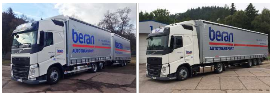
Obrázek 2.10: Kamionové soupravy přívěsová a návěsová. [5]
