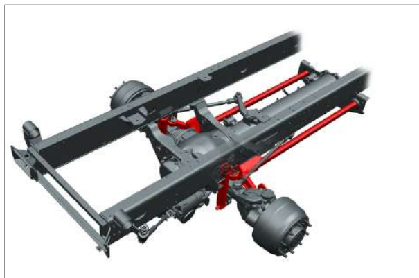
Obrázek 2.39: Tatrovácový podvozek s torzními tyčemi (červená barva) pro odpružení přední nápravy. [19]
