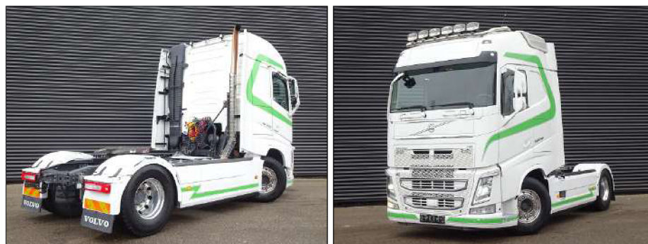
Obrázek 2.9: Tahač návěsů Volvo FH 500 v konfiguraci 4x2. [4]
