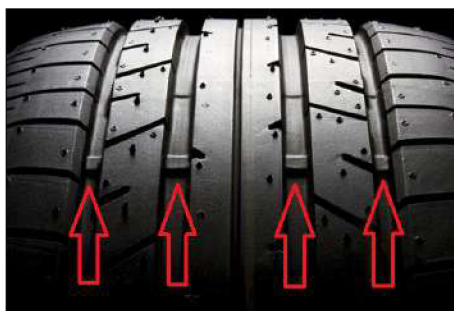
Obrázek 2.16: TWI - indikátor který napomáhá rychlému zjištění, zda běhoun není příliš opotřeben. [22]
