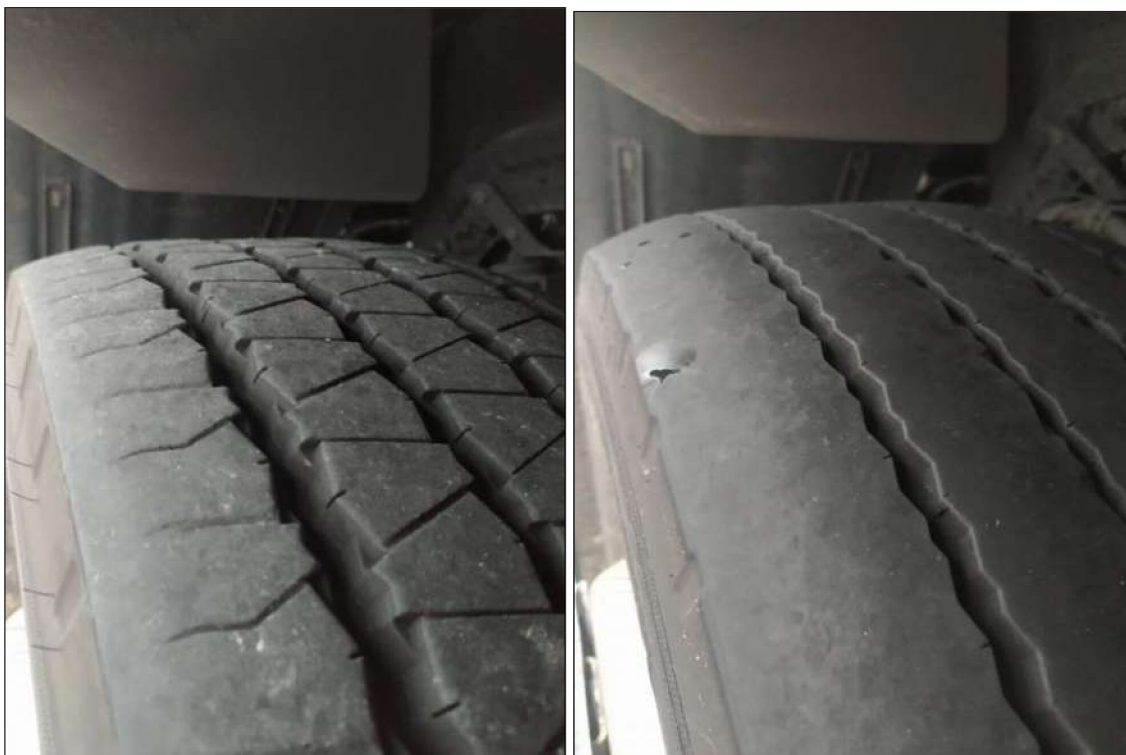
Obrázek 4.6: Fotografie kol po seřízení geometrie a po ujetí přibližně 30 000 km. [11]
