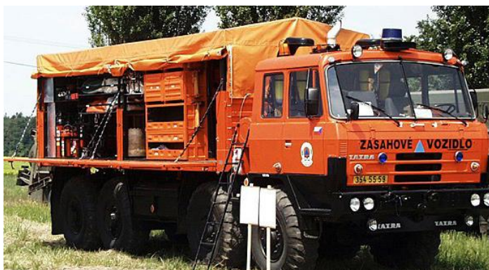
Obrázek 3: Zásahové vozidlo k odstranění ekologických havárií TATRA 815 8x8 VVN
