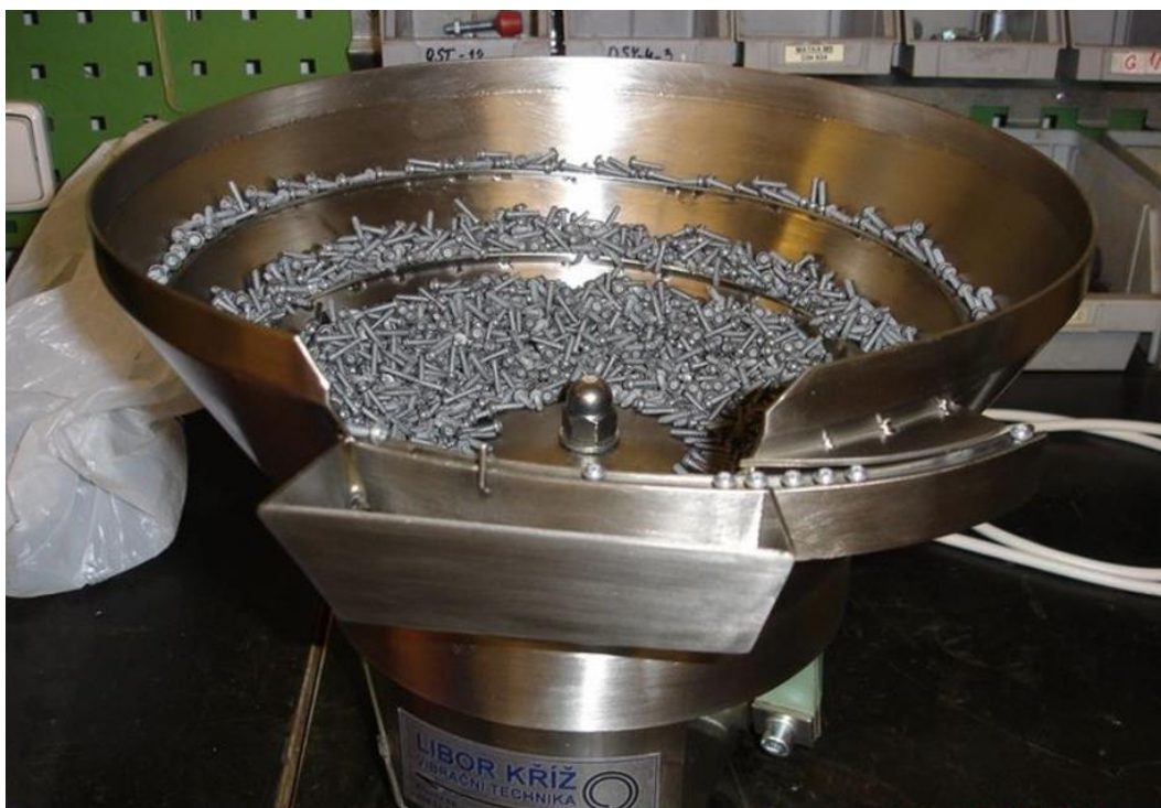
Obr. 24 Vibrační kruhový zásobník KZ 630 C/L [15]
