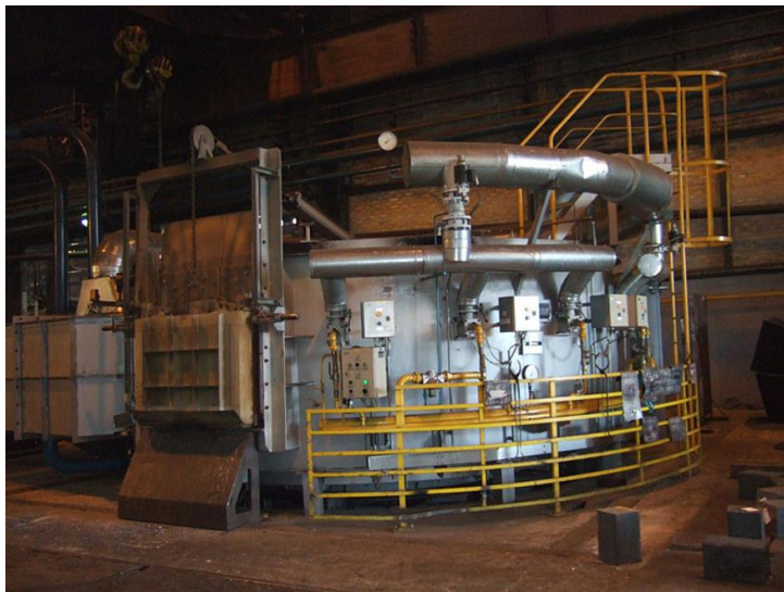
Obr. 25 Plynová karuselová pec [16]
