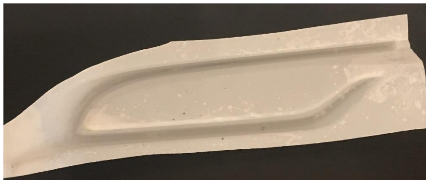
Obr. 3.27: Vzorek č. 2 po uvolnění vnitřního napětí s viditelnými světlými místy
