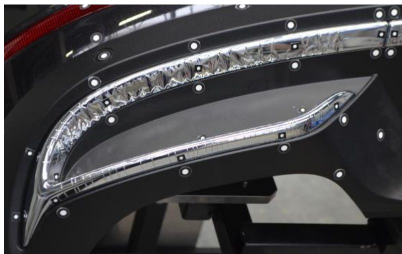
Obr. 3.12: Galvanicky pokovená díl „okrasná tvarová lišta levá“ po 10 cyklech klimatické zkoušky PVI200
