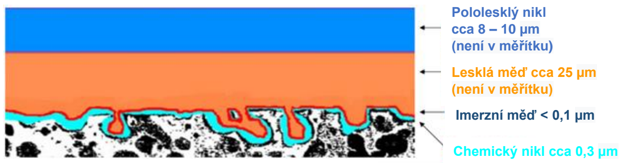
Obr. 2.21: Ukázka povrchu ABS dílu s vrstvou pololesklého niklu [22]
