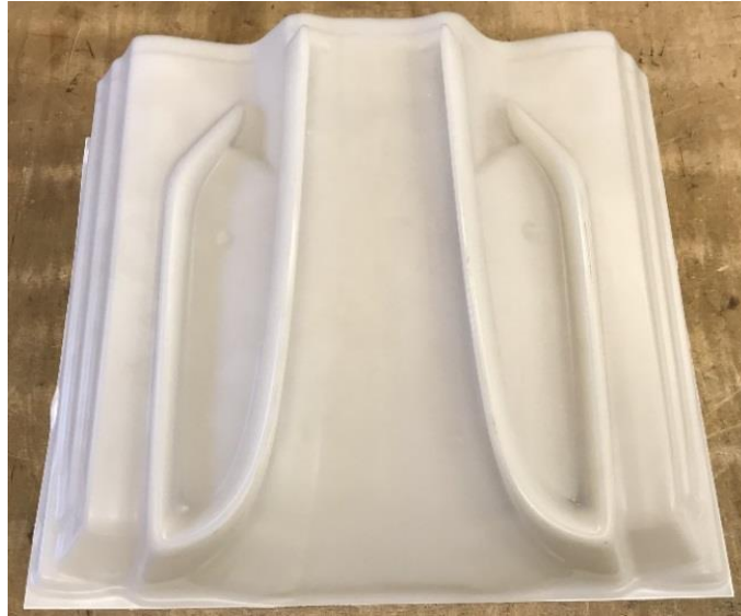
Obr. 3.3: Odstřižený výlisek první série tvarování
