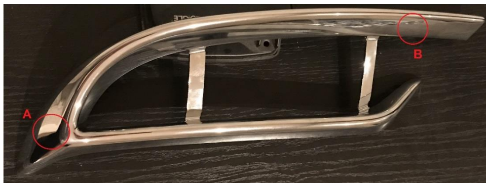
Obr. 3.39: Galvanicky pokovený díl „okrasné tvarové lišty levé“ s vyznačenými pozicemi A a B
