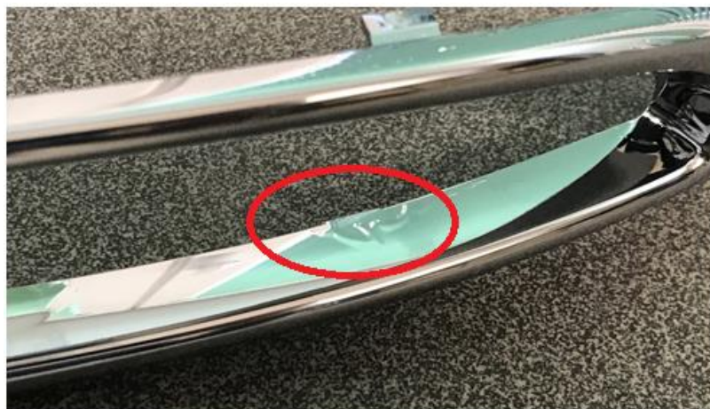
Obr. 3.7: Galvanicky pokovený díl se zvlněným povrchem
