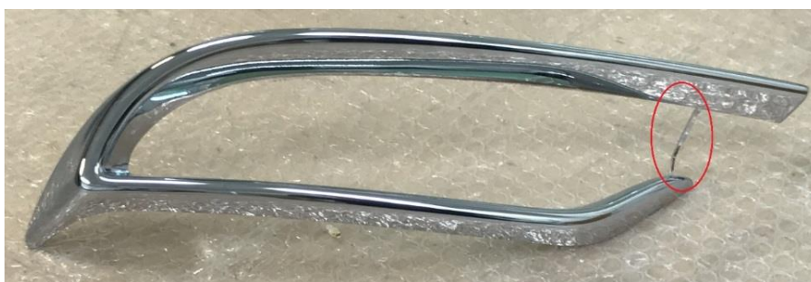
Obr. 3.6: Galvanicky pokovený díl se zvýrazněným spojem volných konců pomocí technologického odpadu výlisku
