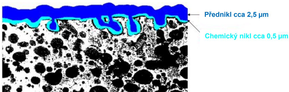
Obr. 2.19: Ukázka povrchu ABS dílu s vrstvou chemického niklu a předniklu [22]
