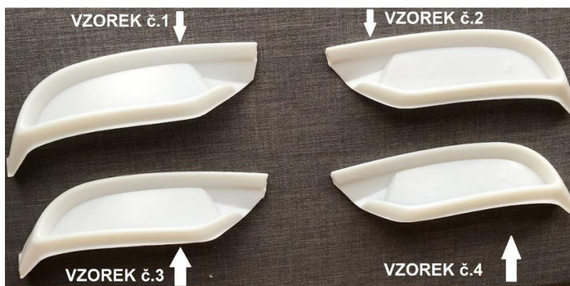
Obr. 3.33: Připravené vzorky druhé série k analýze vnitřního napětí
