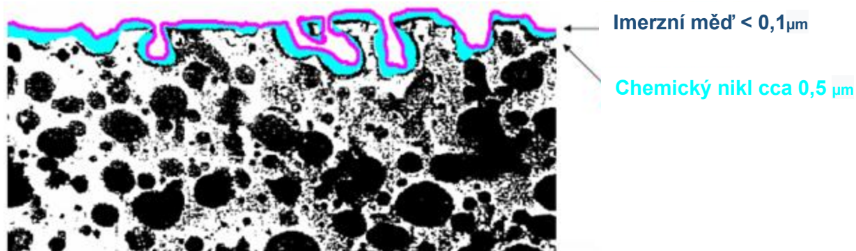
Obr. 2.18: Ukázka povrchu ABS dílu s vrstvou chemického niklu a imerzní mědi [22]
