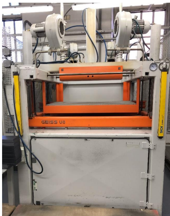
Obr. 3.2: Tvarovací lis GEISS U8 DU 1200/880
