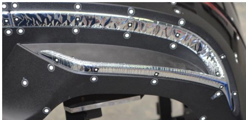
Obr. 3.11: Galvanicky pokovená díl „okrasná tvarová lišta pravá“ po 10 cyklech klimatické zkoušky PVI200
