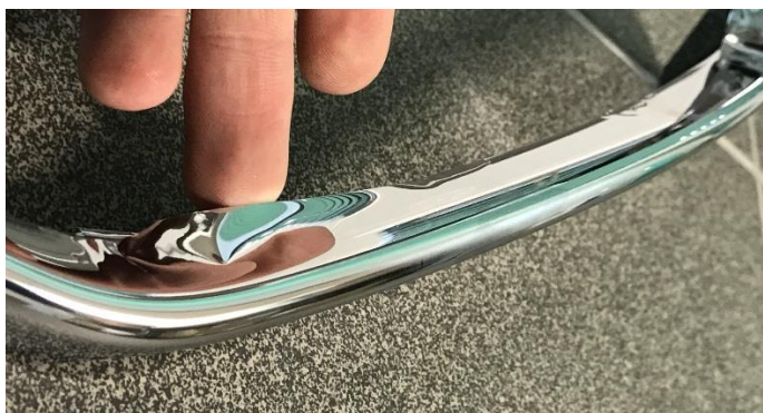
Obr. 3.38: Galvanicky pokovený díl s delaminací povrchu
