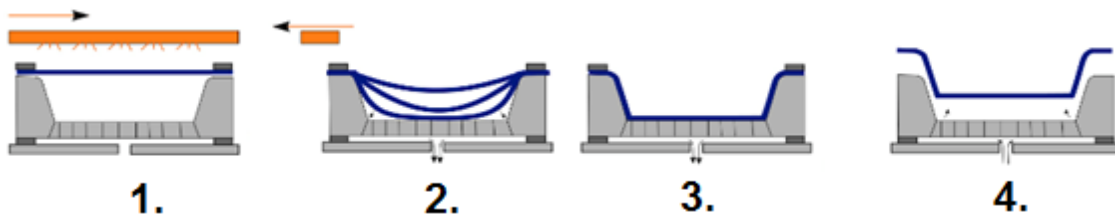
Obr. 2.5: Ukázka principu negativního podtlakového tvarování bez mechanického předtvarování [11]
