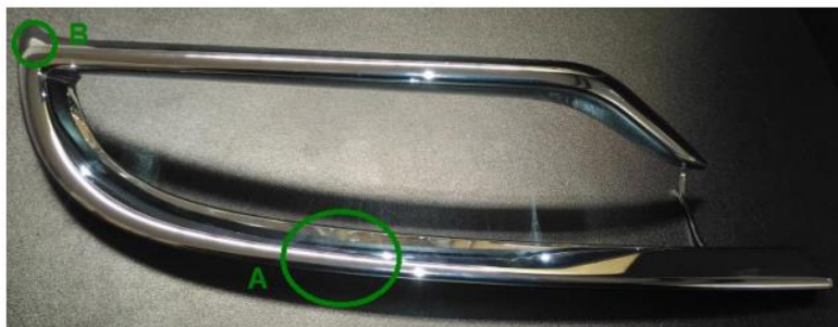
Obr. 3.14: Galvanicky pokovený NOK2 díl s vyznačenou polohou vyříznutých vzorků
