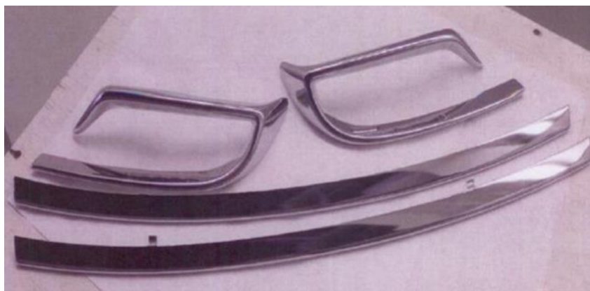
Obr. 3.10: Vybrané galvanicky pokovené díly pro klimatickou zkoušku PV1200
