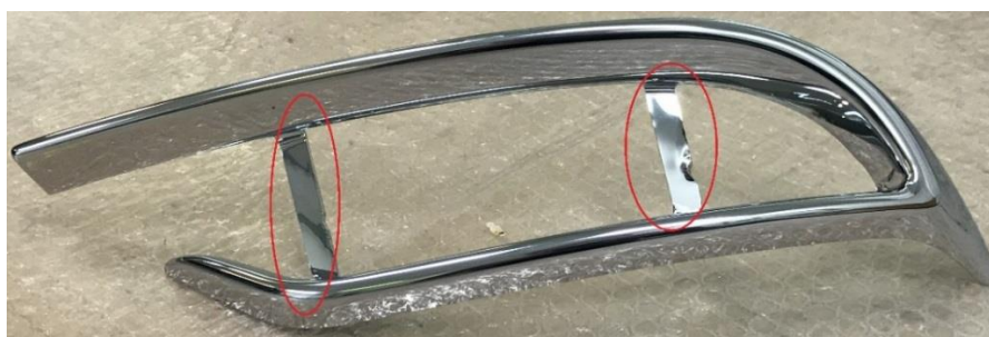
Obr. 3.32: Galvanicky pokovený díl s vyztužujícími prvky (vyznačeno červeně)
