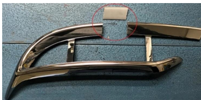
Obr. 3.42: Galvanicky pokovený díl „okrasné tvarová lišta levá“ s vyznačenou polohou vyříznutých vzorků
