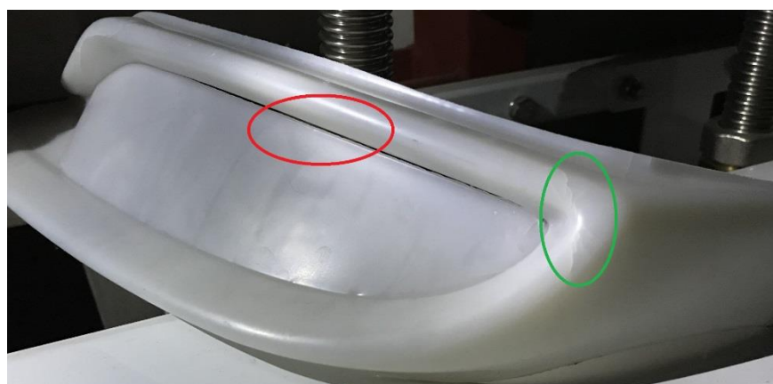
Obr. 3.28: Vzorek č. 3 po uvolnění vnitřního napětí s viditelnými náznaky trhlin (vyznačeno zeleně) a vzniklým protržením materiálu (vyznačeno červeně)
