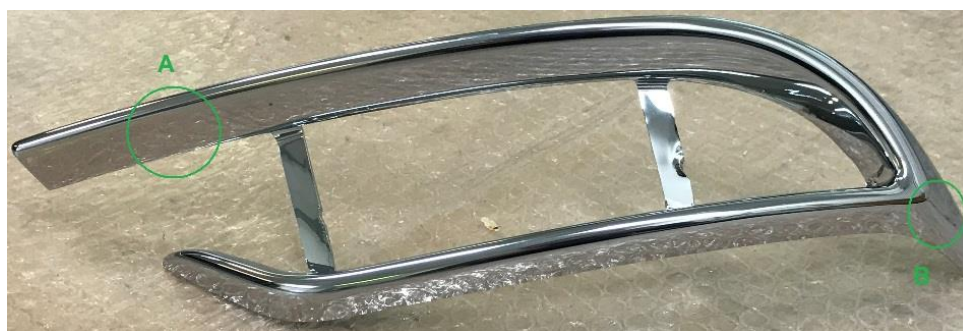
Obr. 3.45: Galvanicky pokovený díl OK2 s vyznačenou polohou vyříznutých vzorků
