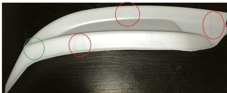
Obr. 3.36: Vzorek č.3 se světlými skvrnami na povrchu (vyznačeno červeně) a s náznakem trhliny (vyznačeno zeleně)
