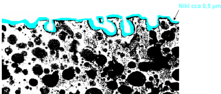
Obr. 2.17: Ukázka povrchu ABS dílu s vrstvou chemického niklu [22]
