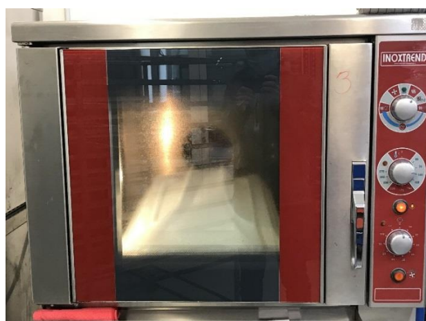
Obr. 3.31: Výlisek druhé série žíhán v peci při 80 °C po dobu 25 s
