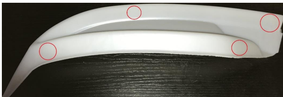
Obr. 3.34: Vzorek č.1 se světlými místy na povrchu (vyznačeno červeně)
