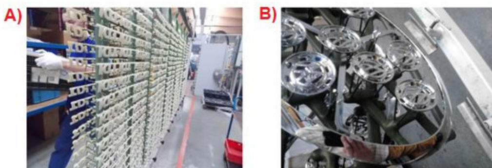
Obr. 2.12: Ukázka typů závěsů A) - závěs pro jednodruhové díly s nepokovenými výrobky, B)- kombinační závěs pro více druhů s pokovenými výrobky [25]
