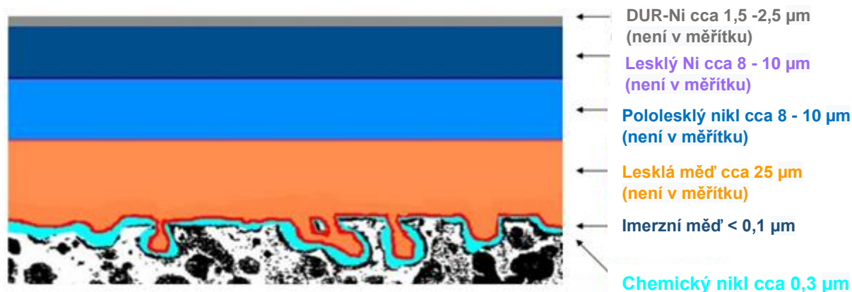
Obr. 2.23: Ukázka povrchu ABS dílu s vrstvou z mikroporézního niklu [22]
