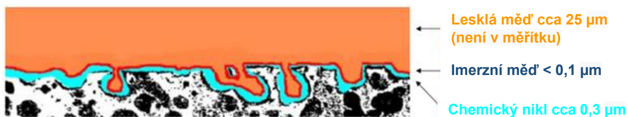
Obr. 2.20: Ukázka povrchu ABS dílu s vrstvou chemického niklu, imerzní mědi a lesklé mědi [22]
