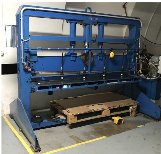
Obr. 2.2: Nůžky pro řezání desek: tabulové (vlevo), pákové (vpravo)
