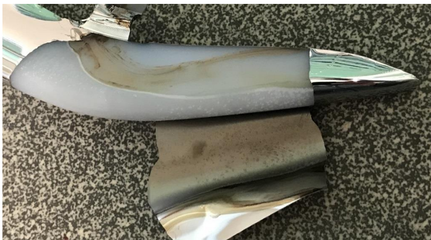
Obr. 3.8: Galvanicky pokovený díl s odloupnutou chromovou vrstvou
