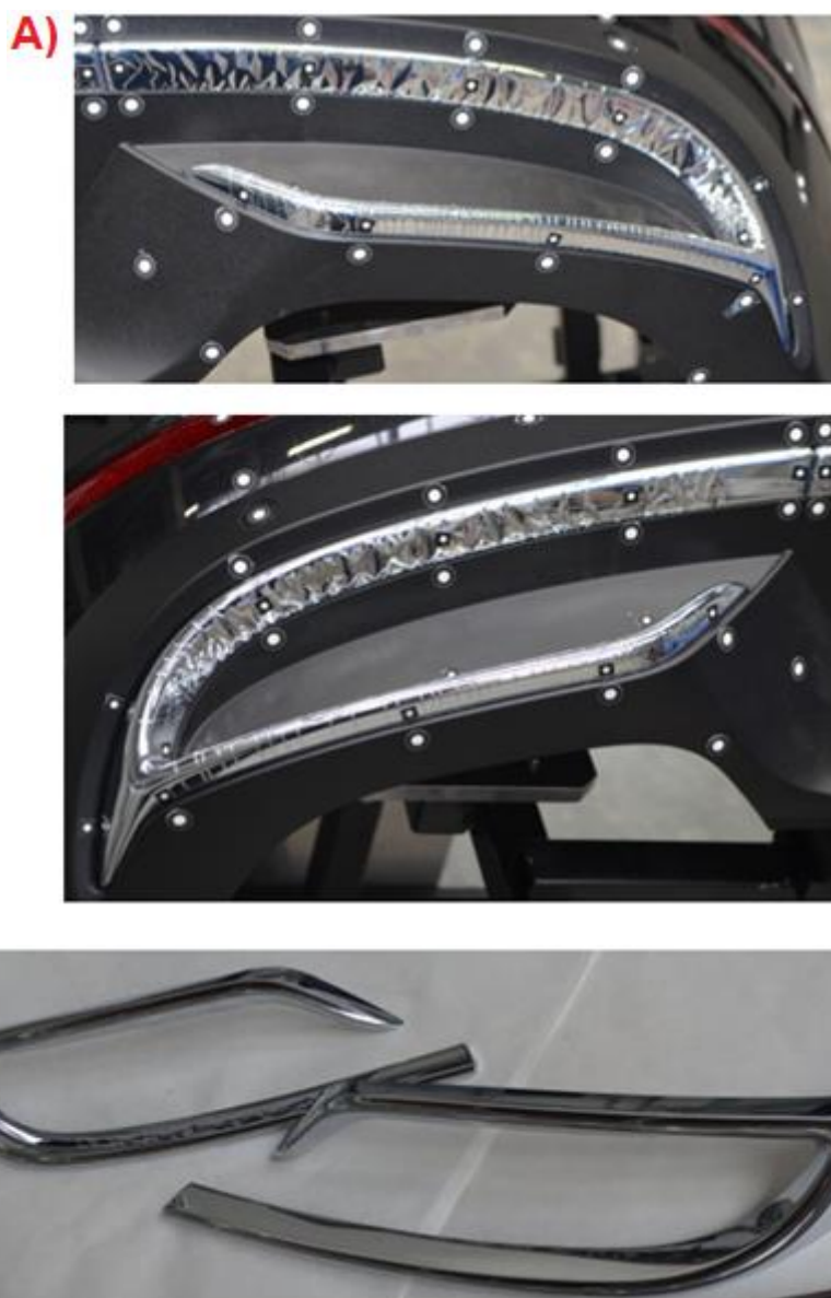
Obr. 4.6: Porovnání dílů po provedených klimatických zkouškách PVI200 A) galvanicky pokovený díl první série po 10 cyklech, B) galvanicky pokovený díl druhé série po 20 cyklech
