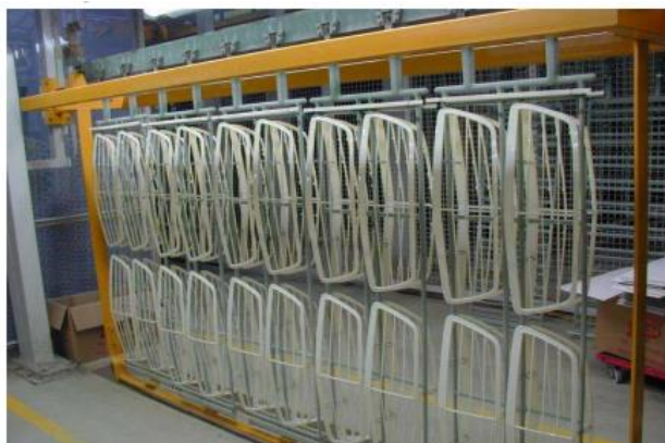
Obr. 2.11: Nepochromované díly upevněné na závěsu
