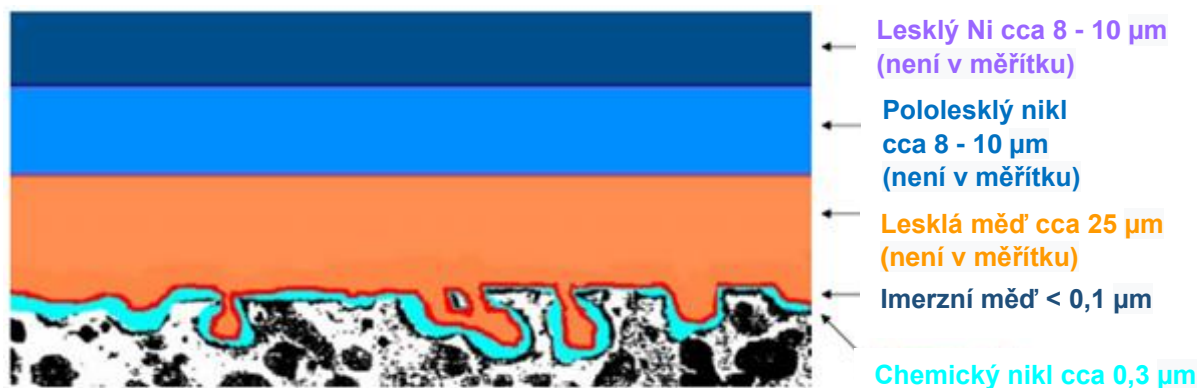
Obr. 2.22: Ukázka povrchu ABS dílu s vrstvou z lesklého niklu [22]
