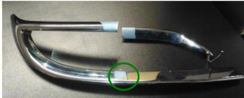
Obr. 3.18: Galvanicky pokovený díl „okrasné tvarová lišta pravá“ s vyznačenou polohou vyříznutých vzorků
