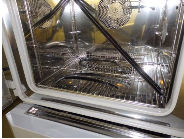
Obr. 3.47: Vybraná „okrasná tvarová lišta levá“ v klimatické komoře
