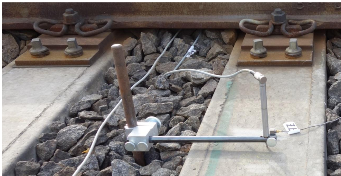
Obr. 5.1.1 Indukční snímač pohybu pražce nainstalovaný v koleji
