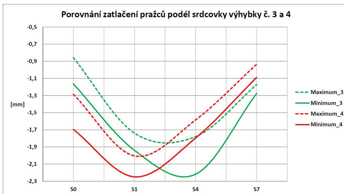
Obr. 9.1.2.1 Srovnání průhybových křivek pražců podél srdcovky výhybky – první měřicí kampaň [5]
