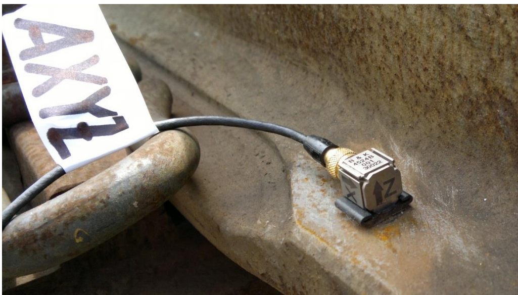
Obr. 5.2.1 Tříosý akcelerometr umístěný na patě křídlové kolejnice
