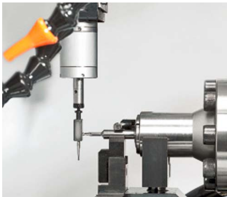
Obr. 4.8 Meranie a polohovanie obrobnku Heli-Sondou [26]
