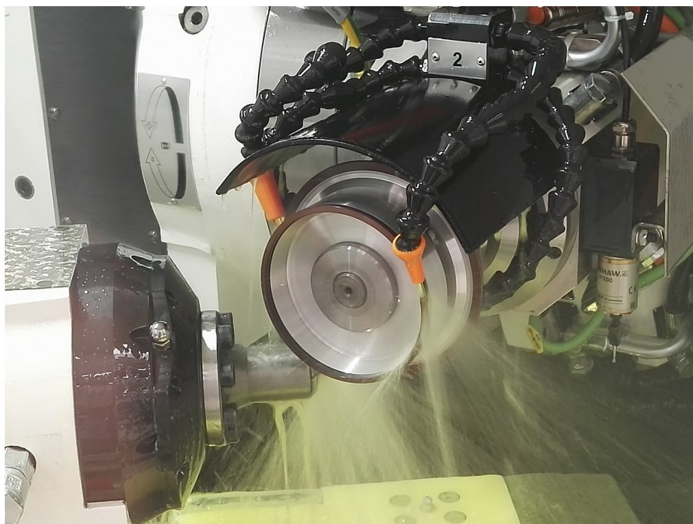
Obr. 4.9 Vzorová ukážka použitia procesnej kvapaliny pri brúsení
