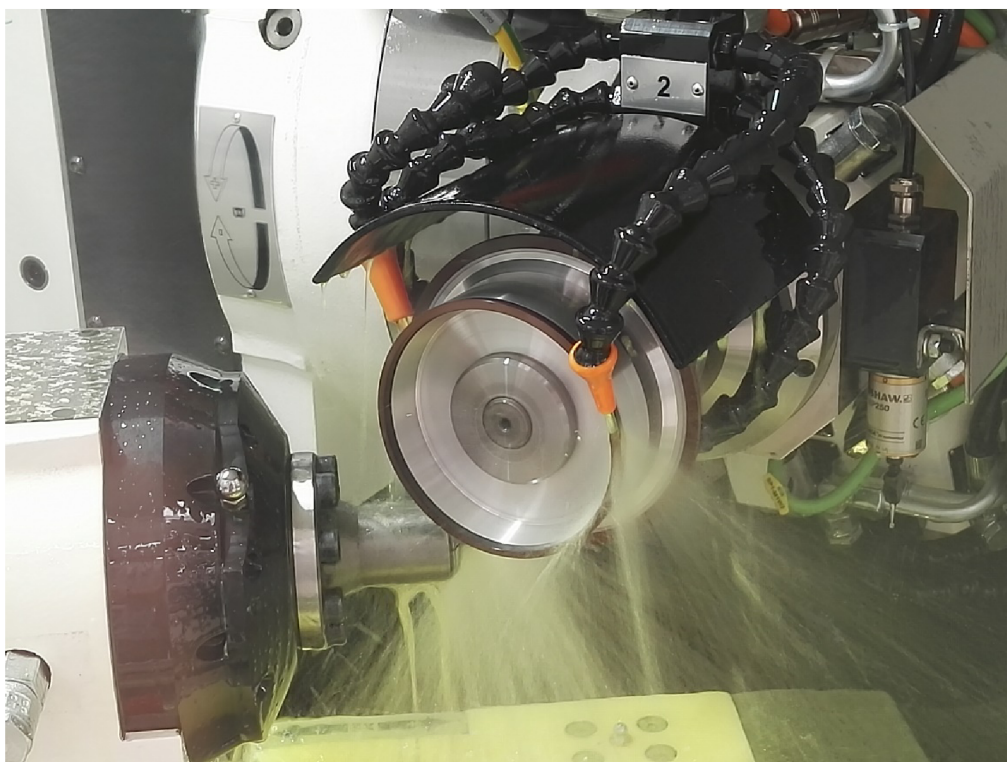
Obr. 4.9 Vzorová ukážka použitia procesnej kvapaliny pri brúsení
