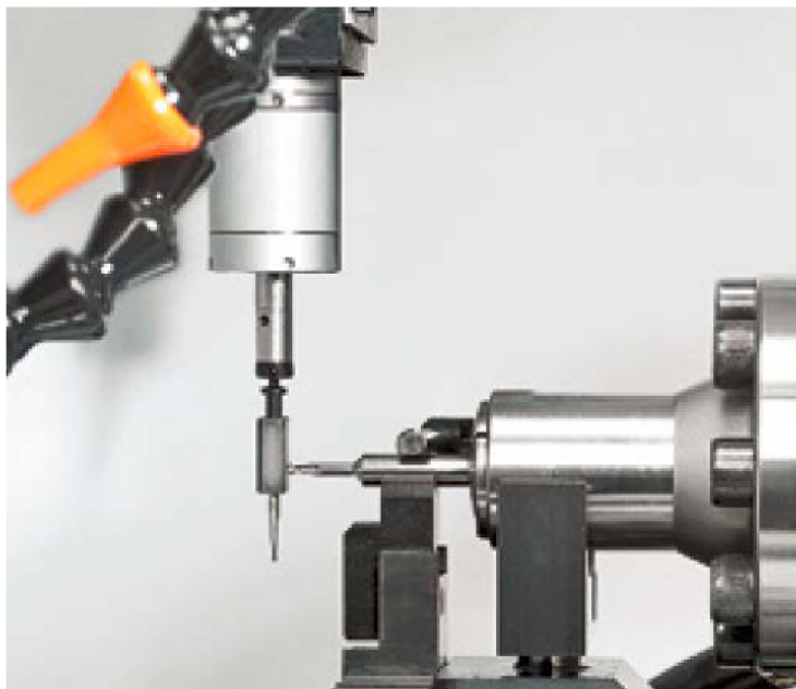
Obr. 4.8 Meranie a polohovanie obrobnku Heli-Sondou [26]
