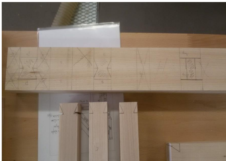
Obrázek 9 Značení na materiál. Interní zdroj
