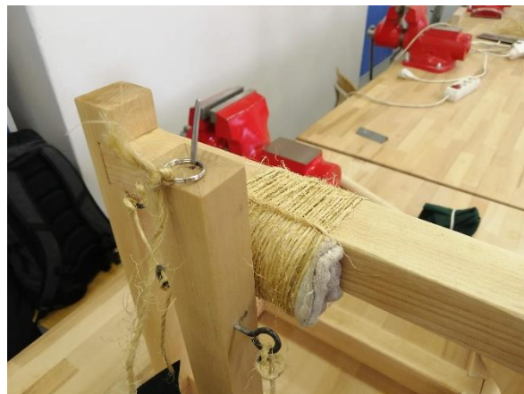
Obrázek 15 Detail vystřelovacího trnu. Interní zdroj
