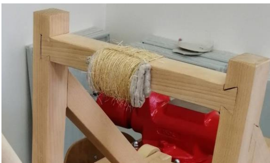
Obrázek 14 Místo vyztužení. Interní zdroj
