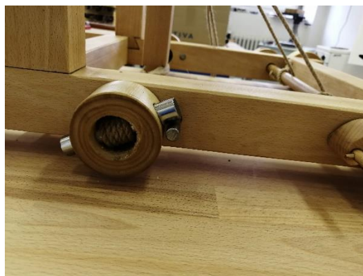
Obrázek 18 Detail uchycení lana na levé straně. Interní zdroj
