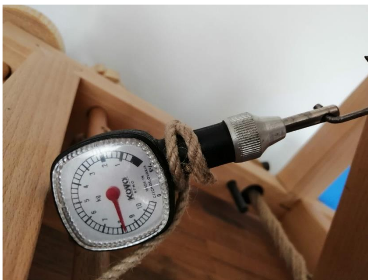
Obrázek 16 Měření síly nátahu. Interní zdroj
