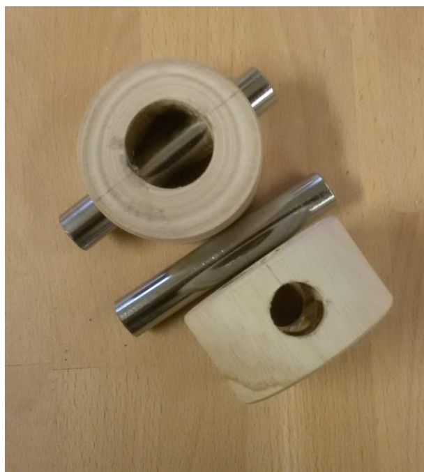
Obrázek 13 Dřevěná "ložiska" na uchycení lana. Interní zdroj
