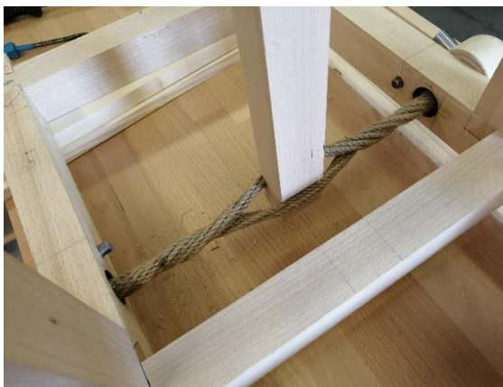
Obrázek 13 Detail napínacího systému. Interní zdroj
