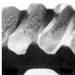
Obr. 26 Vznik pitingů na bocích zubů ozubených kol [7]
