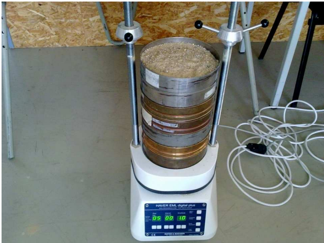
Obr. 33 Stroj pro analytické třídění HAVER EML digital plus
