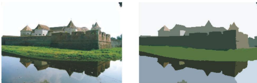
Obrázek 3: Segmentace obrazu vlevo pomocí mean shift algoritmu. Výsledek je vpravo, kde vypočtené segmenty jsou vykresleny stejnou barvou. Obrázek je převzat ze článku [8].
