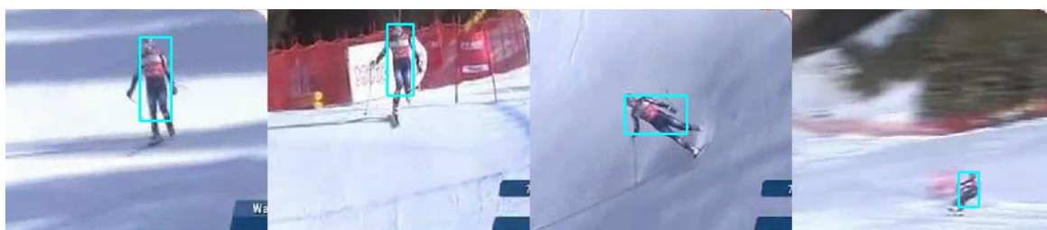
Obrázek 24: Ilustrace principu zadávání k-snímků. Postupně zleva: Původní k-snímek, v němž začíná sledování. K-snímek přidán kvůli velké změně barev na pozadí. K-snímek určující změnu natočení objektu vůči kameře. K-snímek určující vzdálení se objektu od kamery a opětovnou změnu pozadí.
