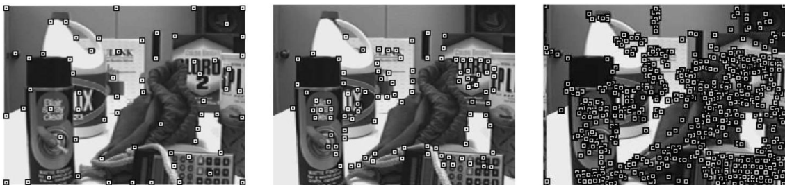
Obrázek 2: Detekované zájmové body pomocí (zleva) Harrisova, KLT a SIFT detektoru. Obrázek je převzat ze článku [32].
