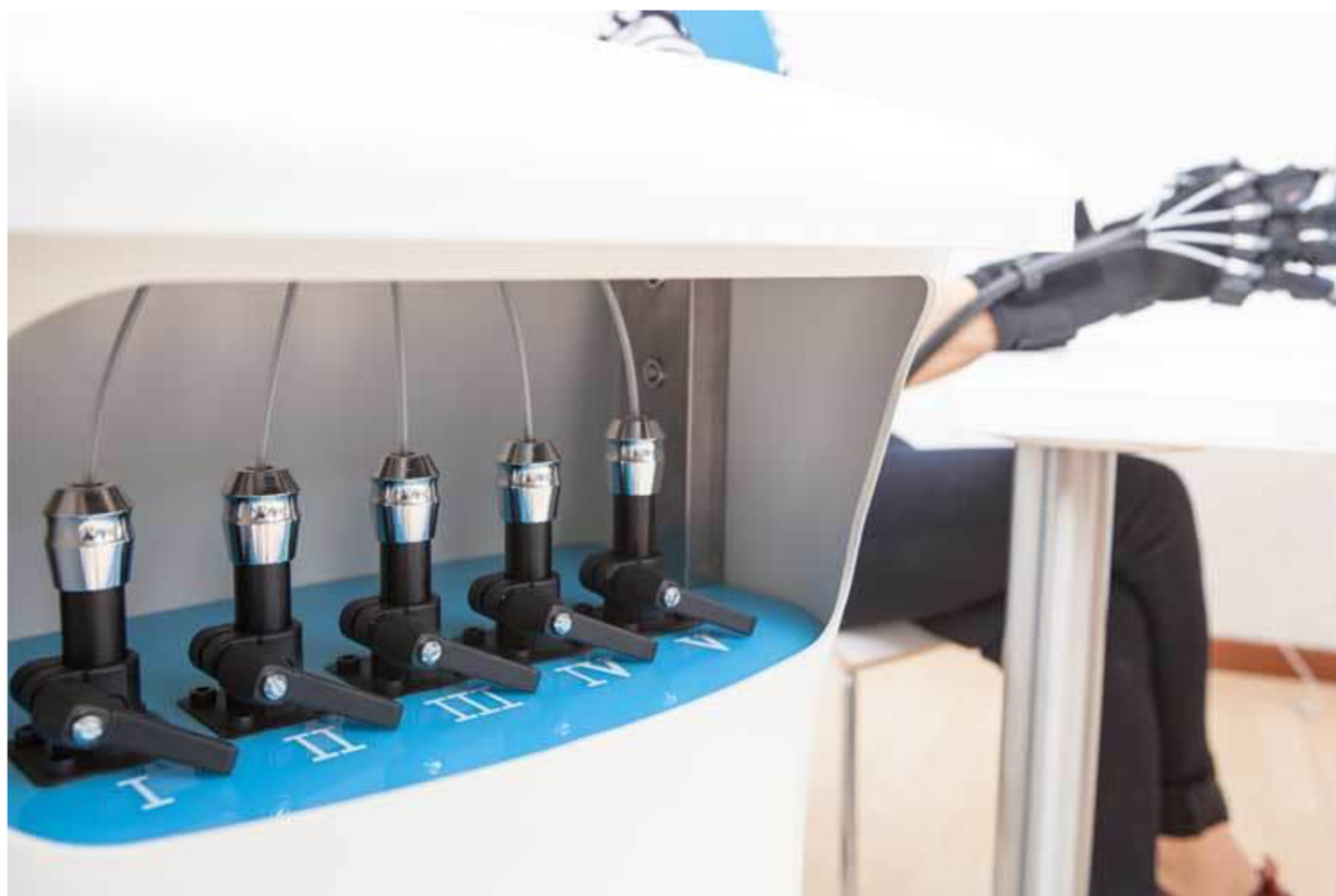
Obrázek č. 2: Pneumatický pohon jednotlivých prstů (www.btl.cz).
